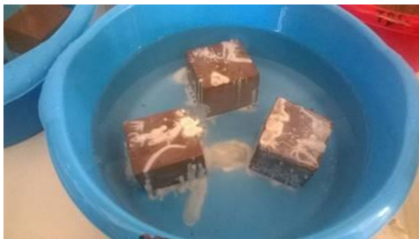
Σχήμα 4.7: Γεωπολυμερή από πλακάκια και ερυθρά ιλύ μετά από εμβάπτιση σε θαλασσινό νερό
