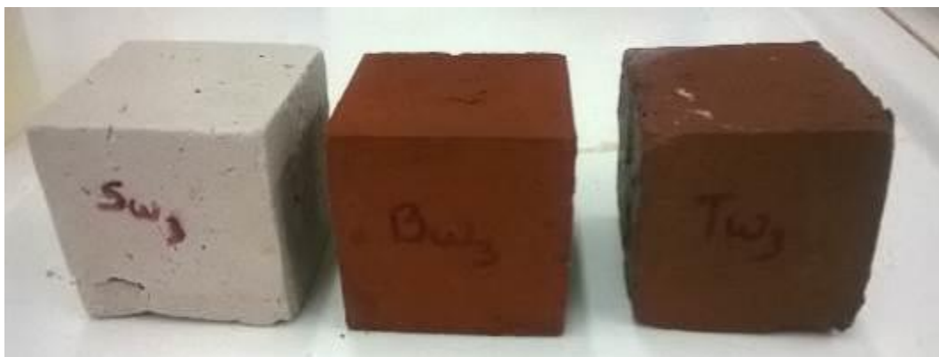
Σχήμα 4.6: Γεωπολυμερή από σκυρόδεμα, τούβλα και πλακάκια ακμής 5 cm (αριστερά προς δεξιά) μετά από εμβάπτιση σε απιονισμένο νερό
