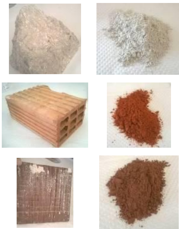
Σχήμα 4.1: Σκυρόδεμα, τούβλα και πλακάκια (από πάνω προς τα κάτω) πριν και μετά τη λειοτρίβηση
