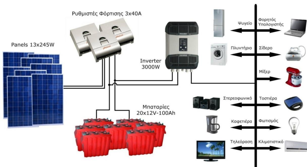
Σχήμα 3.1: Συνδεσμολογία φωτοβολταϊκής εγκατάστασης
