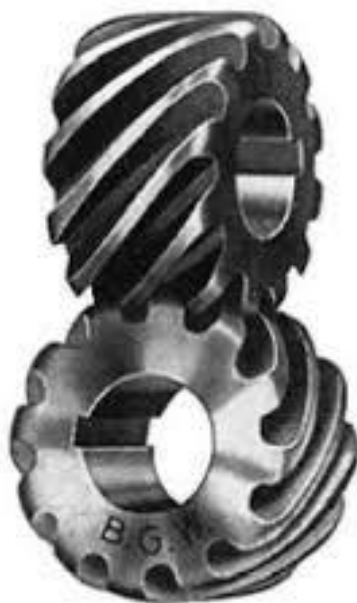
Σχήμα 2.5: Μοντέλο ζεύγους ελικοειδών τροχών ασυμβάτων αξόνων
