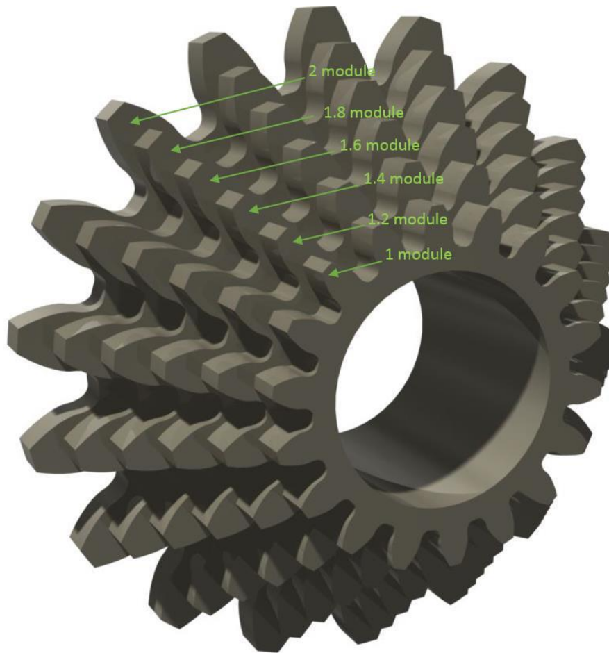
Σχήμα 2.8: Οδοντώσεις με ίδιο αριθμό οδόντων και διαφορετικό module
