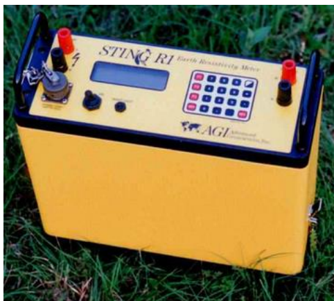
Εικόνα 6-2. Όργανο StingR1 / Swift της AGI Inc που χρησιμοποιήθηκε για τις γεωηλεκτρικές τομογραφίες FRAGLINE 1 και FRAGLINE 2.
