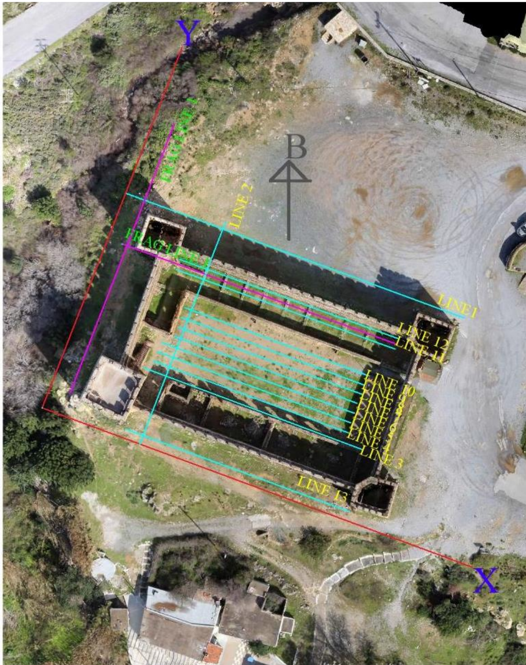
Εικόνα 6-4. Το Φραγκοκάστελλο σε κάτοψη με σχεδιασμένες τις γραμμές της ηλεκτρικής τομογραφίας.
