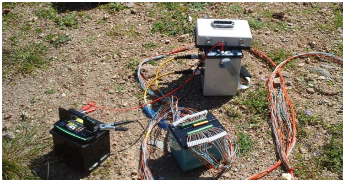
Εικόνα 6-3. Το όργανο Syscal Pro, IRIS. Επίσης φαίνεται ο πολυπλέκτης των 48 καναλιών. Αυτά χρησιμοποιήθηκαν για τις υπόλοιπες τομογραφίες.
