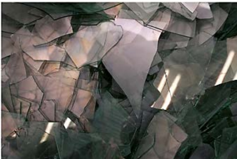
Εικόνα 50 Σπασμένα τμήματα πινάκων λεπτού υμενίου μετά την αφαίρεση των μεταλλικών στοιχείων και ύστερα από καθαρισμό. [109]
