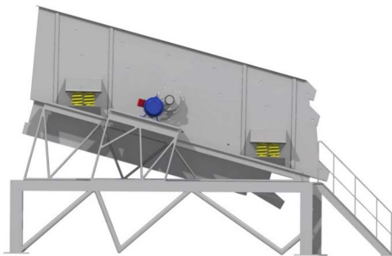
Εικόνα 73 Δονητικός μηχανισμός διαχωρισμού (Πλάγια όψη).
