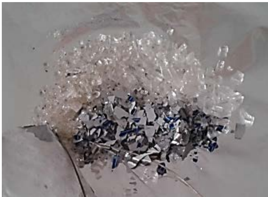
Εικόνα 65 Εργαστηριακό αποτέλεσμα θρυμματισμού (Πρόχειρη διαλογή). [CADLAB]
