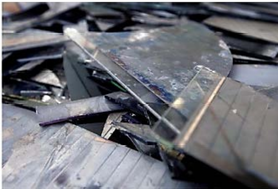
Εικόνα 49 Σπασμένοι πίνακες λεπτού υμενίου πριν την αφαίρεση των μεταλλικών στοιχείων. [109]
