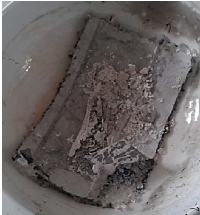
Εικόνα 59 Τμήμα φ/β πίνακα (20mm*10mm) μετά από θερμική επεξεργασία. [CADLAB]
