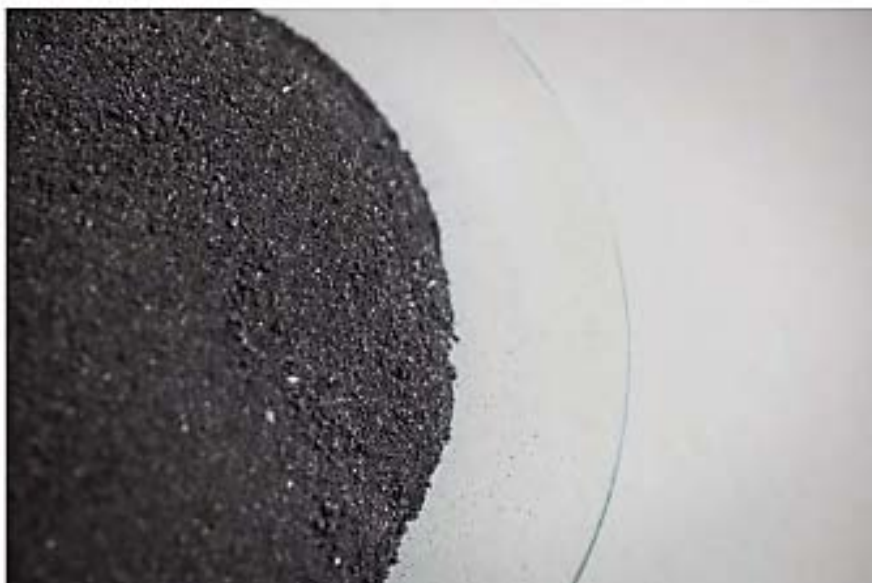
Εικόνα 51 Ετερογενές μείγμα μαύρου χρώματος που προέκυψε ύστερα από την επεξεργασία για την ανακύκλωση του CdTe. Περιέχει 92% Cd και 6% Mo. [109]
