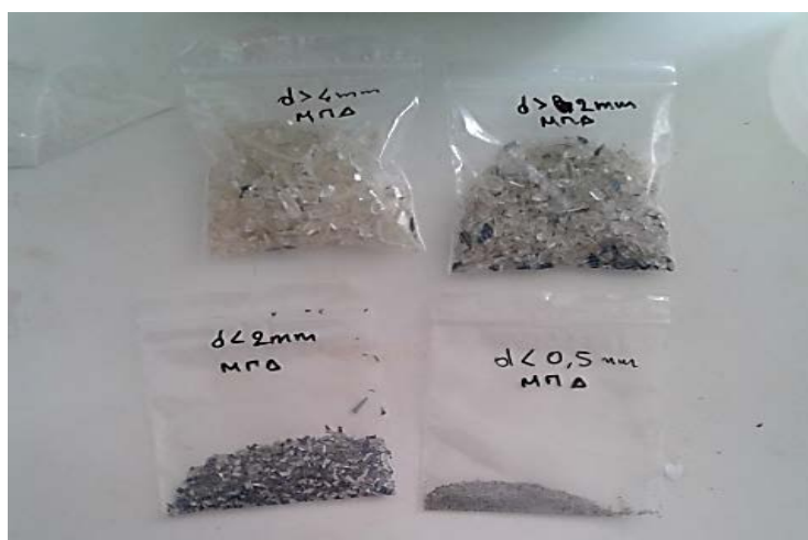
Εικόνα 75 Εργαστηριακά αποτελέσματα μηχανικού διαχωρισμού με διαφορετικές ποσοστώσεις γυαλιού-πυριτίου. Από αριστερά προς τα δεξιά: 95/5 ( d > 4mm ), 80/20 ( 4mm > d > 2mm ), 5/95 ( d < 2mm ). [CADLAB]
