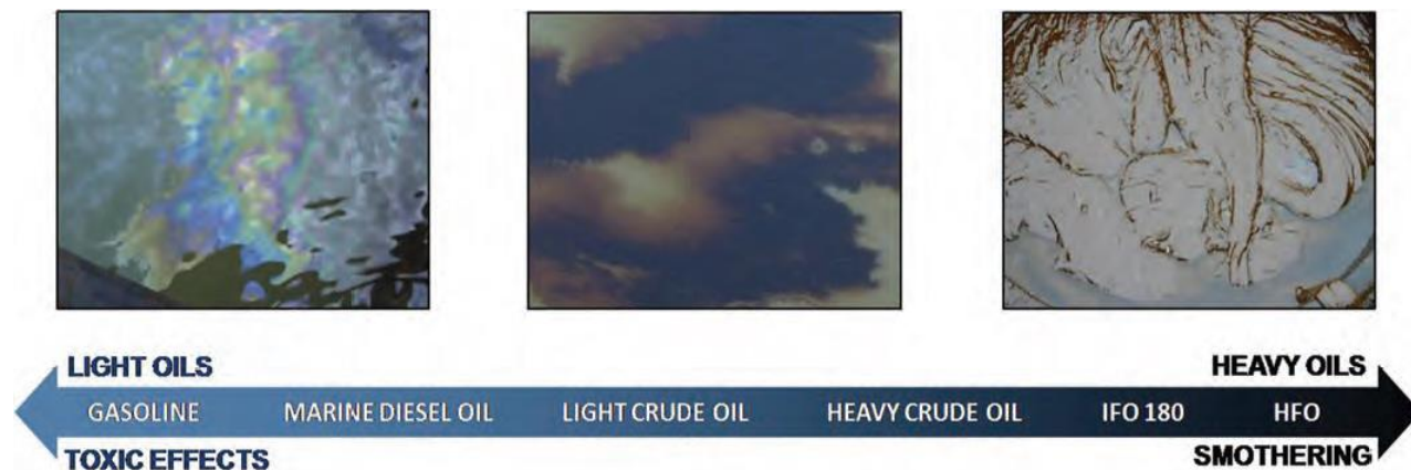
Εικόνα 2.5: Επιπτώσεις στους θαλάσσιους οργανισμούς διαφόρων κλασμάτων του πετρελαίου [Πηγή ITOPF]
