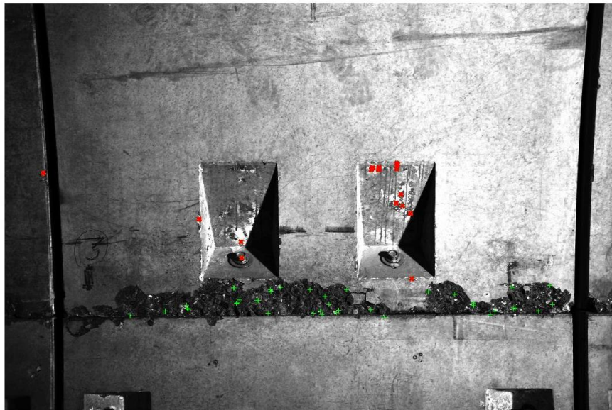
Εικόνα 3.20 : Η χειρότερη φωτογραφία θρυμματισμών για τον FAST είναι η 27 και έχει το μικρότερο Precision 68,33% στα 60 σημεία ανίχνευσης διότι βρίσκει 41 σημεία ενδιαφέροντος. Αστοχούν 19 σημεία(κόκκινοι σταυροί).
