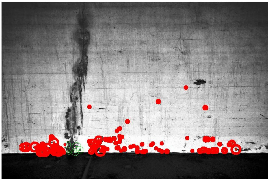
Εικόνα 3.22 : Η χειρότερη φωτογραφία ρωγμών για τον SURF η οποία είναι η 4 και έχει πολύ μικρό μέσο Precision 3,28%. Εδώ βλέπουμε πως αντιδρά στα 100 σημεία ανίχνευσης. Βρίσκει 5 σημεία ενδιαφέροντος με Precision 5%. Τα πράσινα σημεία είναι αυτά που έχουν ευστοχήσει.
