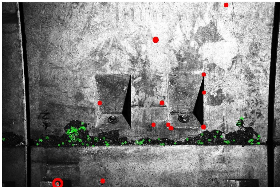
Εικόνα 3.23 : Η καλύτερη φωτογραφία θρυμματισμού για τον SURF είναι η 31. Έχει μέσο Precision 94,98 % και εμφανίζει 100% Precision σε αρκετές περιπτώσεις. Σε αυτή την εικόνα βλέπουμε όταν έχει το μικρότερο Precision 86,32% στα 95 σημεία ανίχνευσης και βρίσκει 82 σημεία ενδιαφέροντος. Τα 13 κόκκινα σημεία συμβολίζουν τις αστοχίες.
