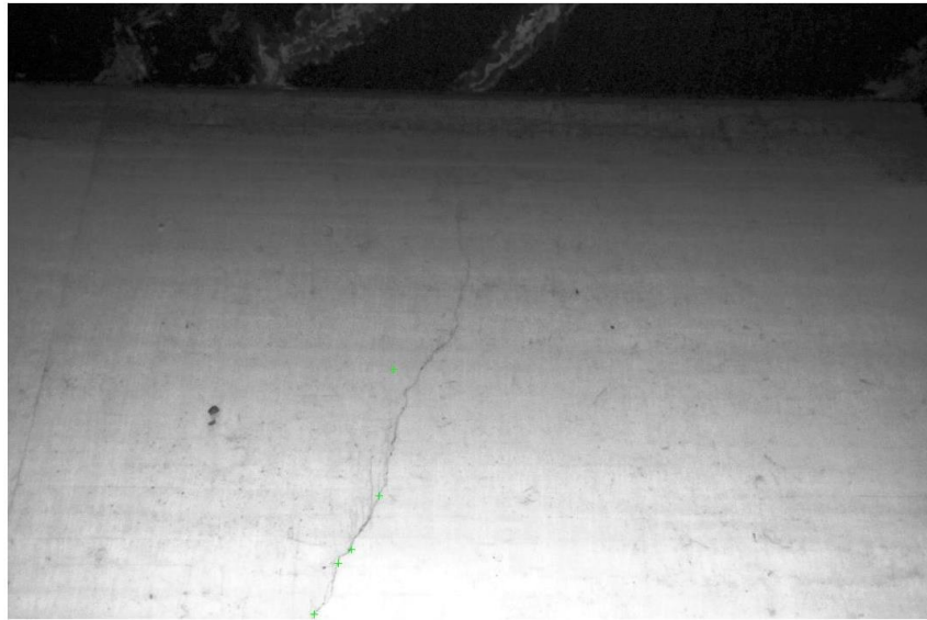
Εικόνα 3.9 : Η καλύτερη φωτογραφία ρωγμών για τον Harris είναι η 5 και έχει καλύτερο Precision 100% στα 5 σημεία ανίχνευσης
