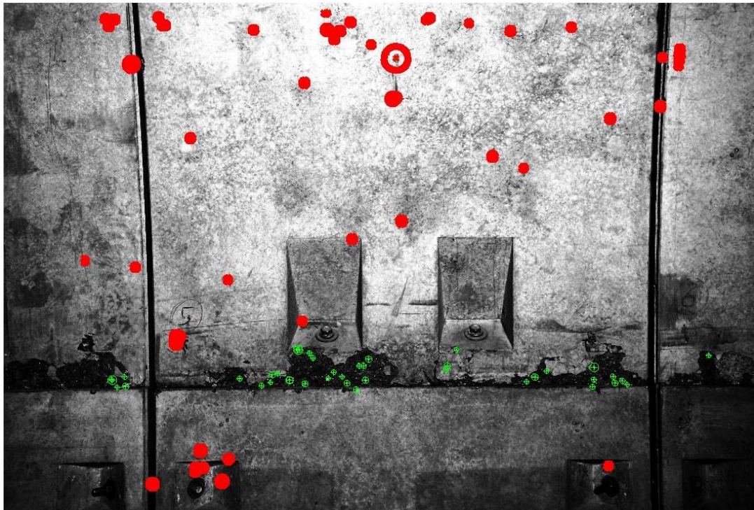
Εικόνα 3.24: Η χειρότερη φωτογραφία θρυμματισμών για τον SURF είναι η 35 με 63,20% μέσο Precision. Εδώ βλέπουμε όταν έχει το μικρότερο Precision 40% και το εμφανίζει στα 100 σημεία ανίχνευσης. Τα 40 πράσινα σημεία είναι τα σημεία που έχει ευστοχήσει.
