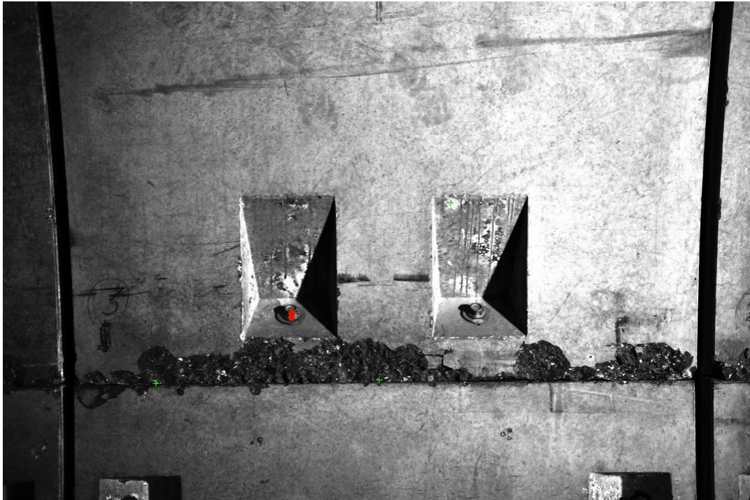
Εικόνα 3.16 : Η χειρότερη φωτογραφία θρυμματισμών για τον Shi-Tomasi(MinEigen) είναι η 27 και έχει το χειρότερο Precision 60% όταν ψάχνει για 5 σημεία ανίχνευσης. Τότε αστοχούν 2 σημεία με τους κόκκινους σταυρούς.
