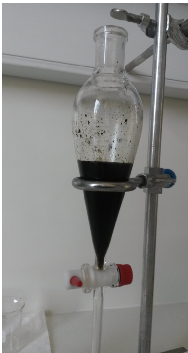
Εικόνα 5.13. Το διάλυμα μετά τον εξατμιστήρα σε χοάνη διαχωρισμού φάσης
