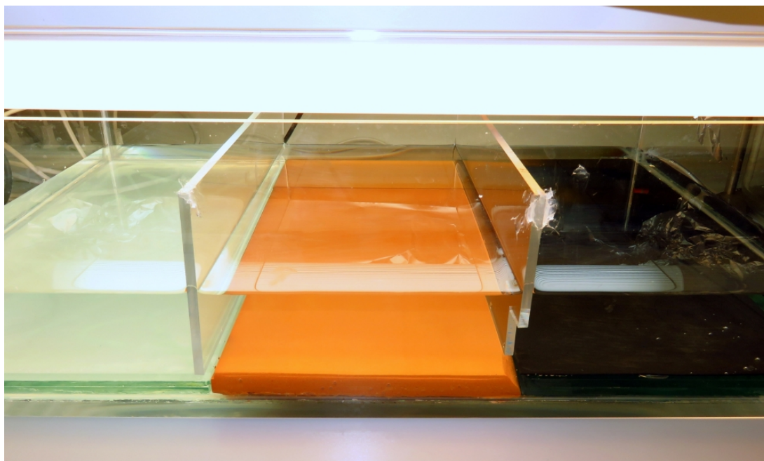
Εικόνα 5.1. Μπροστινή άποψη του Φωτο-βιοαντιδραστήρα κατά την έναρξη πειράματος καλλιέργειας μικροφυκών πάνω σε γυαλί αμμοβολής, κεραμικό υλικό και πολυαιθυλένιο
