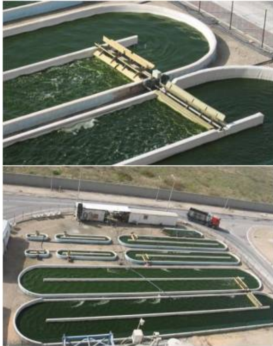
Εικόνα 2.1. Ανοικτά συστήματα καλλιέργειας ( Open Ponds )
