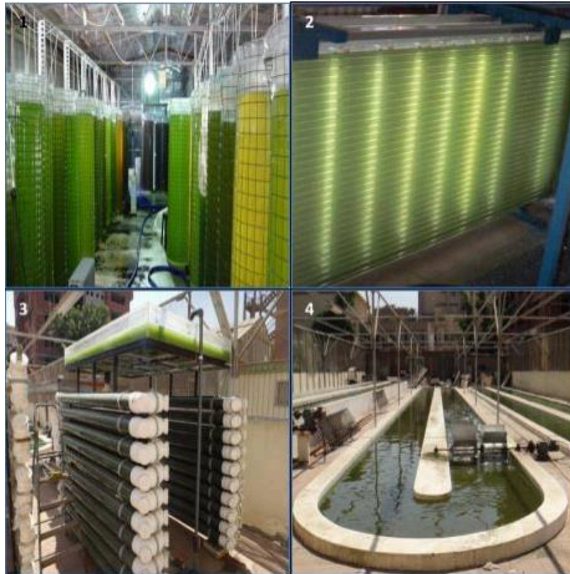
Εικόνα 2.3. Διάφοροι τύποι συστημάτων καλλιέργειας μικροφυκών. (1) Πλαστικοί σάκοι 300 λίτρων, (2) επίπεδοι φωτοαντιδραστήρες, (3) οριζόντιοι σωληνωτοί φωτοαντιδραστήρες και (4) ανοικτή δεξαμενή τύπου raceway
