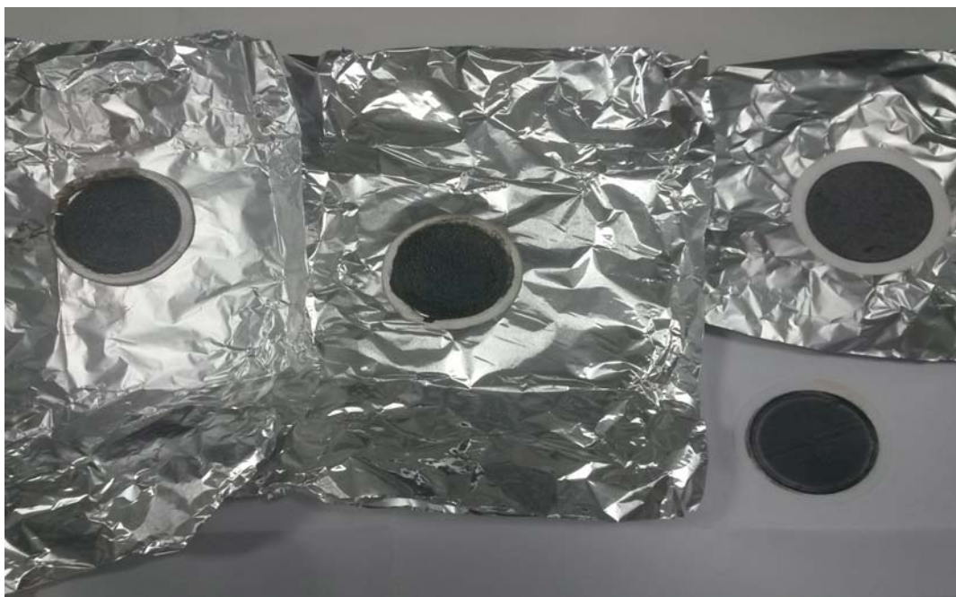
Εικόνα 3.11 Φίλτρα οξειδίου του γραφενίου τα οποία έχουν παρασκευαστεί με διήθηση υπό κενό υδατικών αιωρημάτων οξειδίου του γραφενίου.
