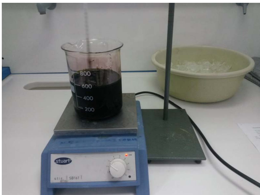
Εικόνα 3.3 Συνεχής ανάδευση του μίγματος της αντίδρασης με συνεχή παρακολούθηση της θερμοκρασίας.
