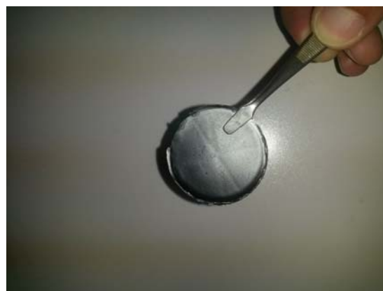
Εικόνα 3.10 Φίλτρα οξειδίου του γραφενίου τα οποία έχουν παρασκευαστεί με διήθηση υπό κενό υδατικών αιωρημάτων οξειδίου του γραφενίου.
