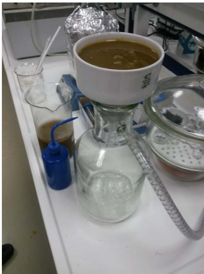
Εικόνα 3.6 Διήθηση υπό κενό σε χωνί τύπου Büchner του μίγματος της αντίδρασης με χρήση διηθητικού χαρτιού για την παραλαβή του οξειδίου του γραφίτη.
