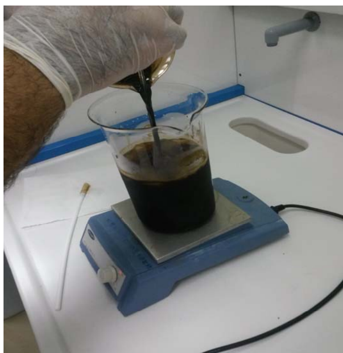
Εικόνα 3.4 Προσθήκη του μίγματος της αντίδρασης σε παγάκια υπερκάθαρου νερού.
