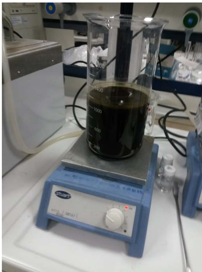
Εικόνα 3.7 Ανάδευση του οξειδίου του γραφίτη με 1 L διαλύματος HCl περιεκτικότητας 3,6% w/w.
