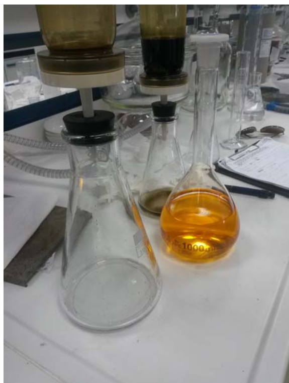
Εικόνα 3.12 Οι δύο διατάξεις διήθησης υπό ελαττωμένη πίεση καθώς και το αρχικό υδατικό διάλυμα της χρωστικής orange II.
