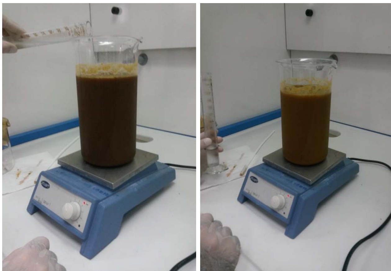
Εικόνα 3.5 Προσθήκη H_2O_2 στο μίγμα της αντίδρασης με σχηματισμό φυσαλίδων και αλλαγή του χρώματος σε κίτρινο-πορτοκαλί.
