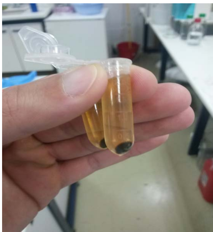
Εικόνα 4.3 Φυγοκέντρηση του αιωρήματος (β) της Εικόνας 4.2 για την απομάκρυνση των αιωρούμενων σωματιδίων οξειδίου του γραφενίου.
