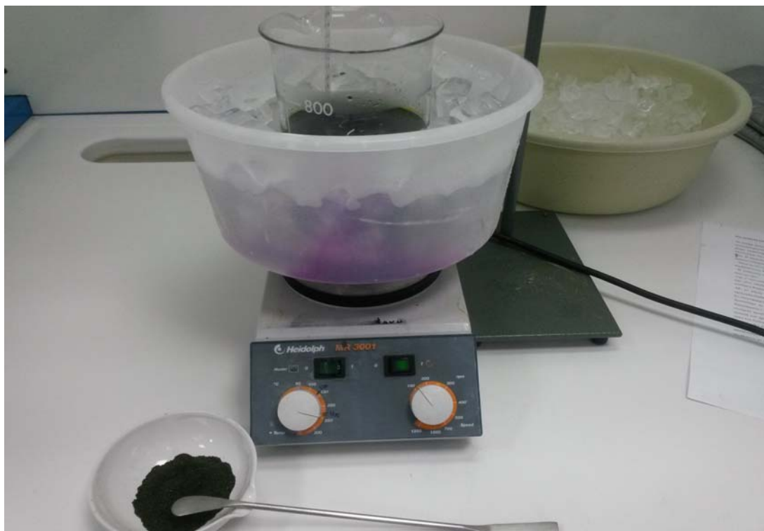
Εικόνα 3.2 Προσθήκη \text{KMnO}_4 στο μίγμα της αντίδρασης σε παγόλουτρο, υπό συνεχή ανάδευση.
