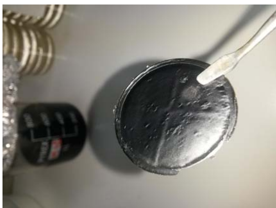
Εικόνα 3.10 Φίλτρα οξειδίου του γραφενίου τα οποία έχουν παρασκευαστεί με διήθηση υπό κενό υδατικών αιωρημάτων οξειδίου του γραφενίου.
