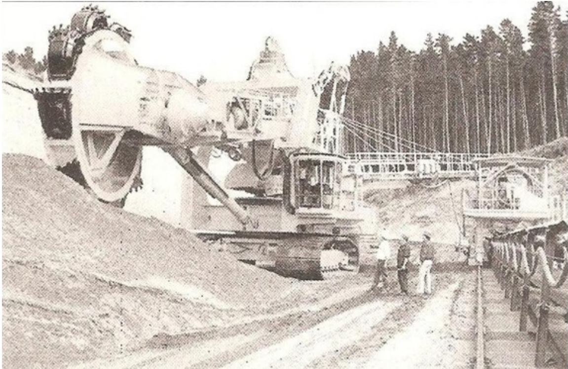
Εικόνα 2-13 Καδοφόρος εκσκαφέας σχεδίασης compact (Κολοβός, 2004)
