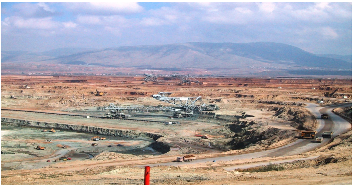
Εικόνα 2-7 Συνδυασμός μεθόδων συνεχούς και ασυνεχούς λειτουργίας στα Ορυχεία Πτολεμαΐδας ( www.oryktosploutos.net )
