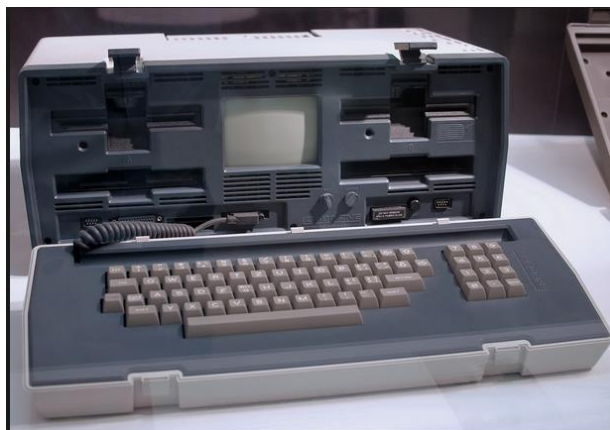
Σχήμα 4.3: Φορητός ηλεκτρονικός υπολογιστής Osbourne 1
