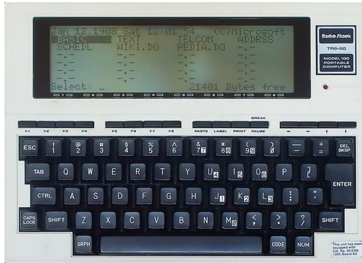
Σχήμα 4.5: Φορητός ηλεκτρονικός υπολογιστής TRS-80 Model 100
