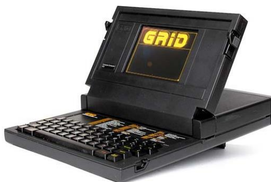
Σχήμα 4.4: Φορητός ηλεκτρονικός υπολογιστής GRiD Compass
