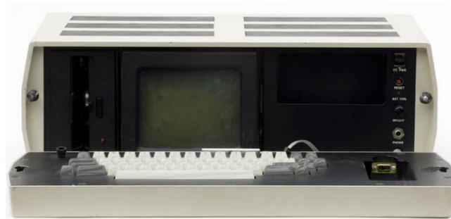
Σχήμα 4.2: Φορητός ηλεκτρονικός υπολογιστής Xerox NoteTaker
