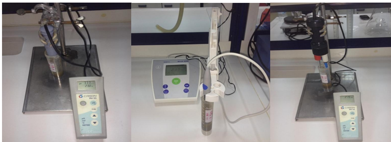
Εικόνα 8: Προσδιορισμός pH, EC και Redox
