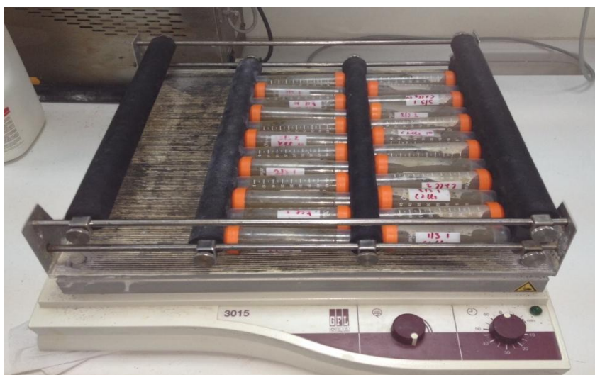
Εικόνα 7: Ανάδευση δειγμάτων - διαλυμάτων
