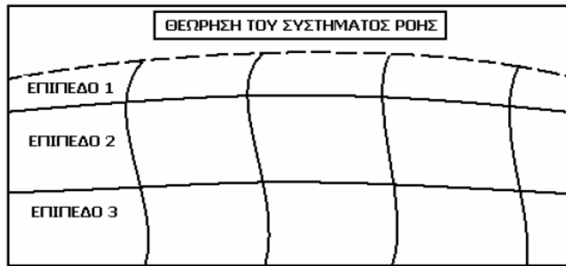
Εικόνα 4.3 Θεωρήσεις συστημάτων υπογείων υδάτων - Θεώρηση συστήματος ροής (Anderson and Woessner, 1992)
