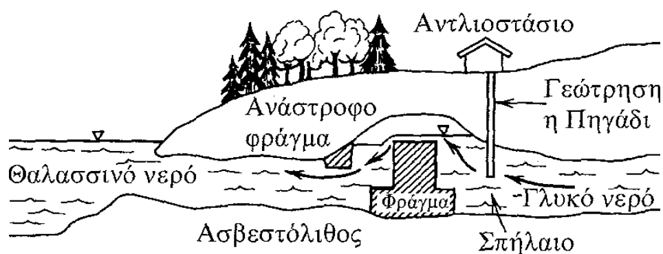
Εικόνα 2.7 Σχηματικό διάγραμμα ενός υπόγειου διαφράγματος, για την παρεμπόδιση ανάμιξης γλυκού και αλμυρού νερού, σε παράκτιο καρστ (Todd, 1980).
