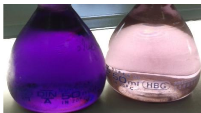
Εικόνα 2, Αριστερά τολουολικό και δεξιά οκτανολικό διάλυμα C 60 .
