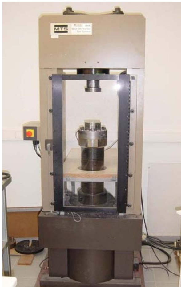
Εικόνα 2.1: Υδραυλική πρέσα μονοαξονικής θλίψης
