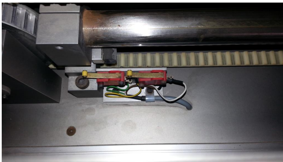
Σχήμα 4.3α: Λεπτομέρεια από τη πειραματική διάταξη της AMIRA LIP100, διακρίνεται ο διακόπτης στο άκρο της μεταλλικής δοκού-οδηγού
