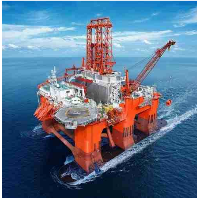
Εικόνα #7. Ημι-υποβρύχια εξέδρα άντλησης. Πηγή Wikipedia.
