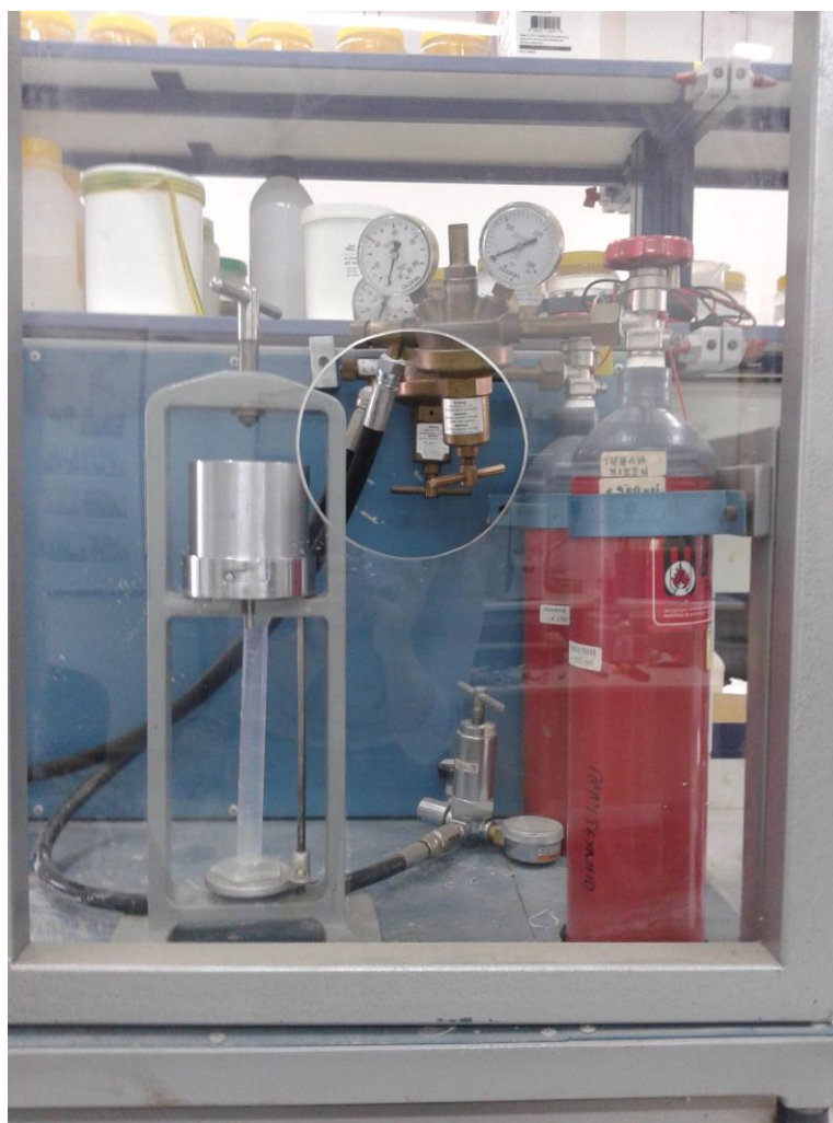
Εικόνα 18 : Φιλτρόπρεσα διήθησης LPLT
