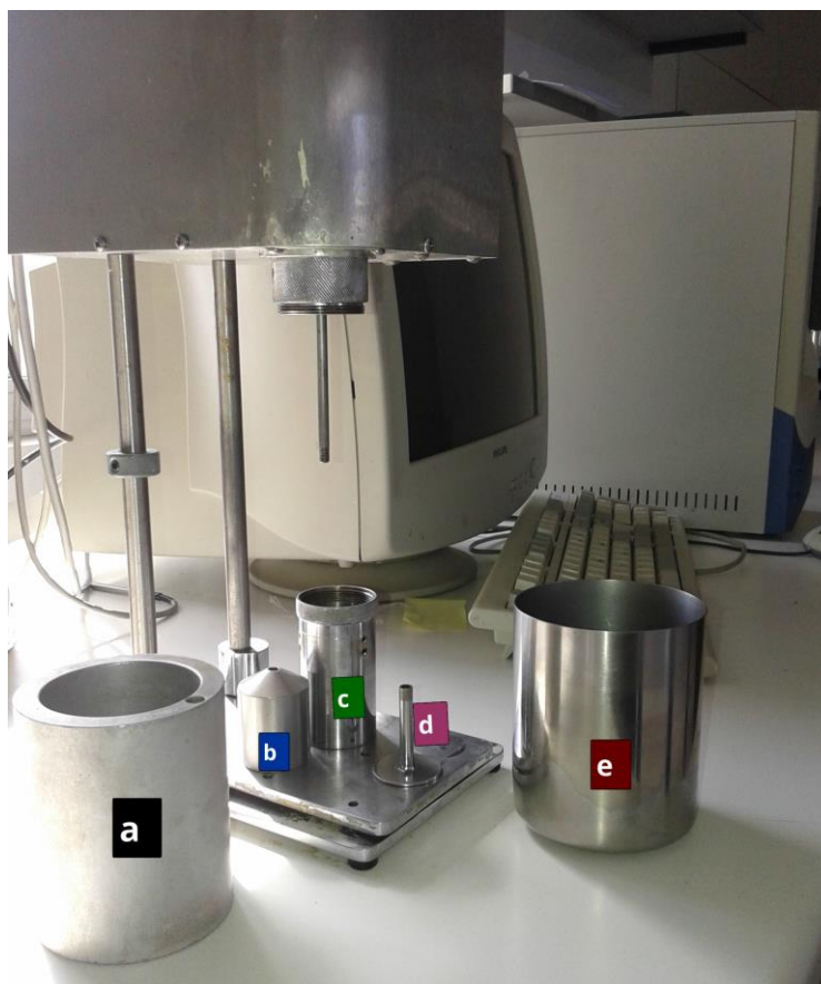
Εικόνα 12 : Μέρη που αποτελούν το ομοαξονικό κυλινδρικό ιξωδόμετρο
