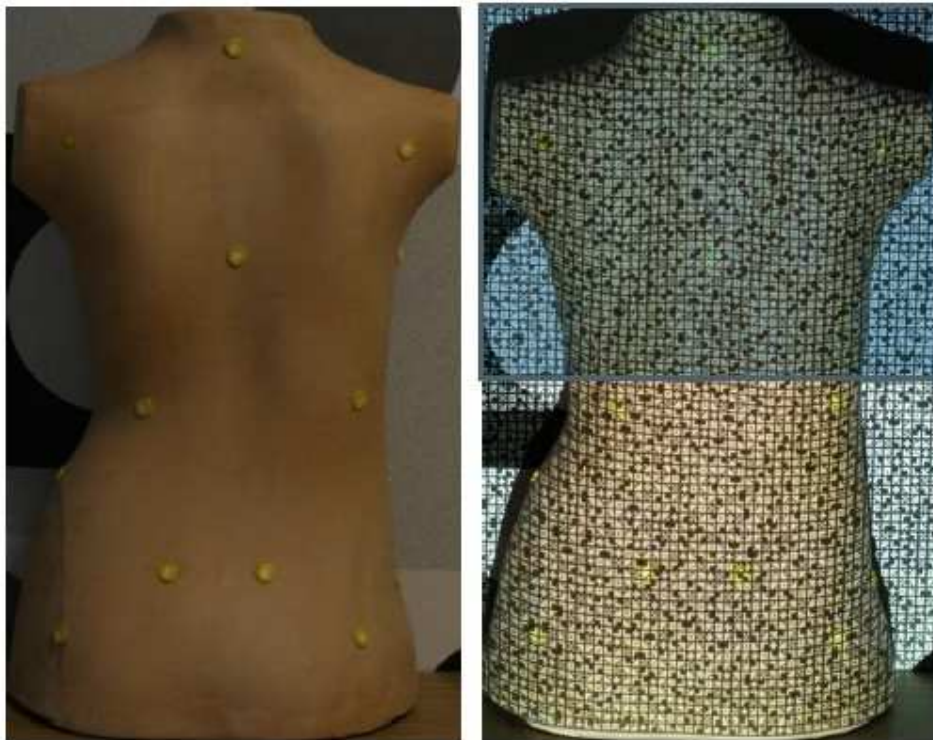
Εικόνα 3.24: Δομημένο Φως. Μοτίβο που περιγράφεται μοναδικά από σημάδια.
