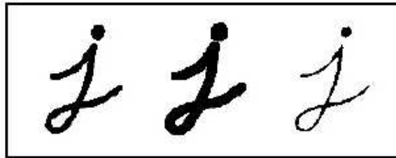
Εικόνα 4.2: Αρχική εικόνα (αριστερά), συστολή εικόνας (κέντρο) και διαστολή εικόνας (δεξιά)
