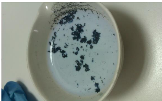
Εικόνα 5.5 Υδρόφοβο RGO (αιώρημα) Επιτυχία αναγωγής και αποτυχία σύζευξης του RGO με το \text{TiO}_2 (HDG5).
