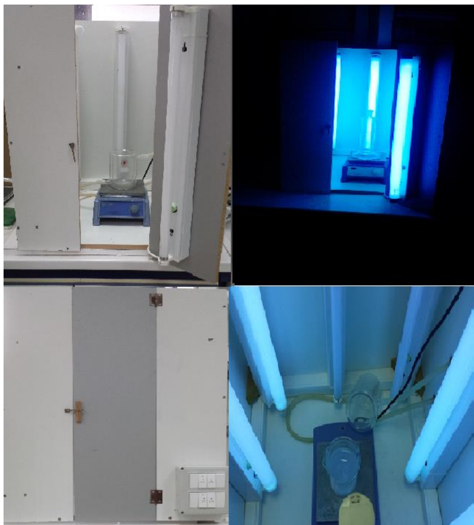
Εικόνα 4.2 (1) Θάλαμος ακτινοβολήσης (με 4 λαμπτήρες F20W/350BL, Sylvania , Blacklight, LAMP UVA)
