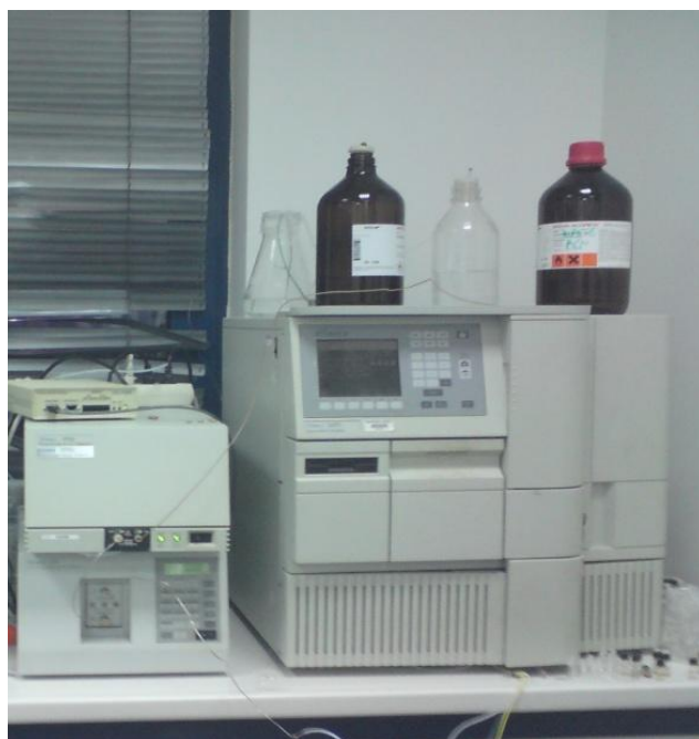
Εικόνα 4.3 High Performance Liquid Chromatography, HPLC) με ανιχνευτές UV/Vis Diode Array (2996 PDA Detector) και φθορισμού (474 Scanning Fluorescence Detector) του οίκου Waters
