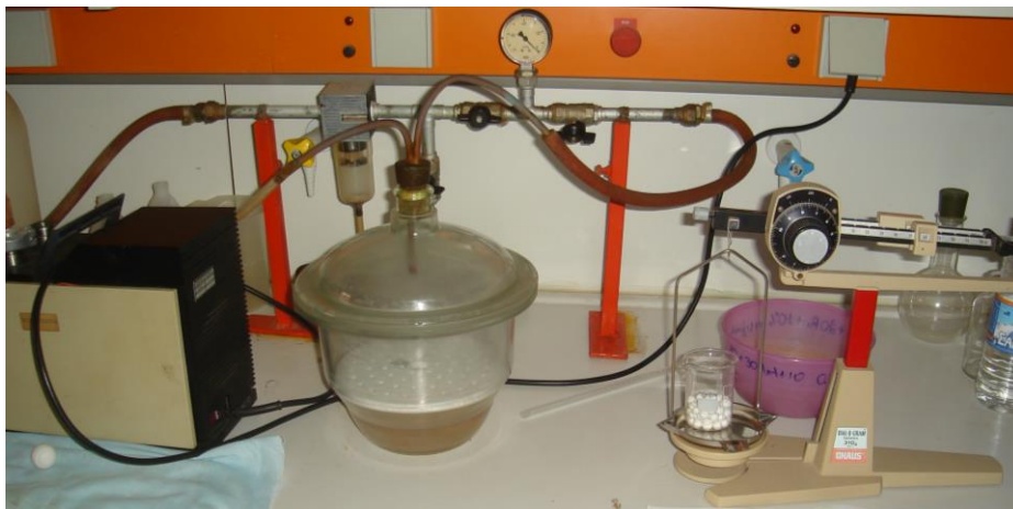
Εικόνα 3.5: Πειραματική διάταξη της μεθόδου DIN EN 993-1 (Εργαστήριο Γενικής & Τεχνικής Ορυκτολογίας).
