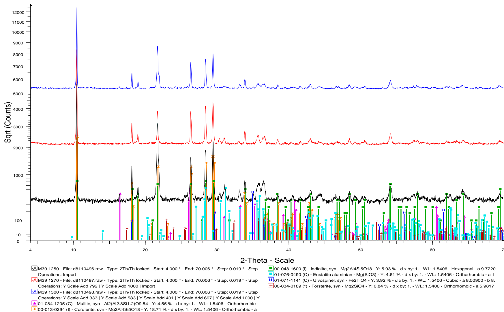
Εικόνα 42: Ακτινογράφημα περιθλασιμετρίας ακτίνων –X των κεραμικών μαζών που προέκυψαν μετά την έψηση της σύνθεσης M39 στους 1250, 1275 και 1300 °C, για διάρκεια έψησης 1 ώρας.
