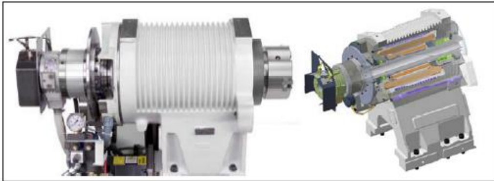
Σχήμα 6. 5 – Αρχή συνολικού σχεδιασμού: ενσωματωμένος κινητήρας, τοποθετημένος σε μία άτρακτο τόνου, από CMZMachineryGroup. Η άτρακτος ψύχεται με λάδι.
