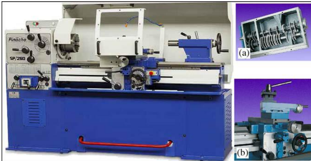
Σχήμα 1. 28–Παράλληλος τόρνος, μοντέλο SP250 από Pinacho. (a) Λεπτομέρεια τροφοδοσίας κιβωτίου. (b) Γενικός πυργίσκος.
