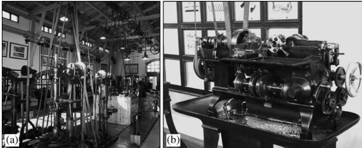
Σχήμα 1. 1 – (a) Μία θεώρηση των καθοδηγούμενων από ιμάντες μηχανών που χρησιμοποιούνται σήμερα στο μουσείο εργαλειομηχανών «Elgoibar» (Ισπανία). (b) Λεπτομέρεια από ένα τύμπανο περιστρεφόμενου πυργίσκου τórνου.
