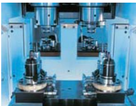
Σχήμα 7. 1 – Λύση μηχανισμού ανύψωσης σε έναν κάθετο τórνο, από Emag.
