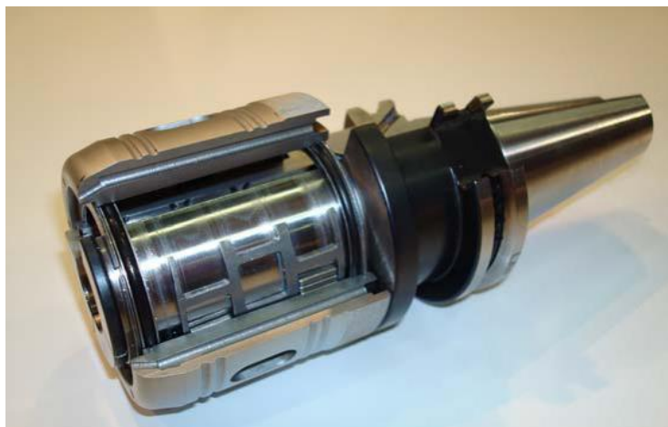
Σχήμα 3. 19 – Τμήμα ενός μηχανισμού σύσφιξης «μεγάλης ισχύος», από την Lair, δείχνονται οι εσωτερικές βελόνες που δημιουργούν την ακτινική δύναμη.
