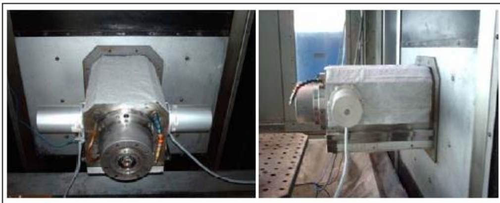
Σχήμα 2. 11 – Τα ADDs που είναι τοποθετημένα πάνω σε ένα έμβολο μίας φραιζας, από Fatronik.
