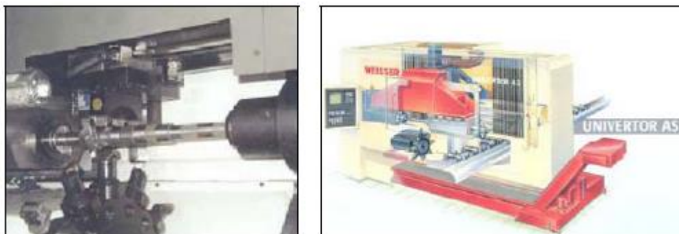
Σχήμα 7. 2 – Λύση μηχανικής ανύψωσης (pickup), από Weisser.
