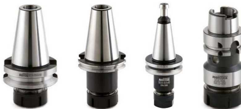
Σχήμα 3. 16 – Τυπικές εργαλειοθήκες από την Maritool, από αριστερά προς τα δεξιά: BT50, CAT50, ISO30, HSK50A.
