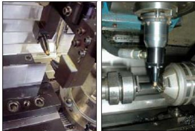
Σχήμα 7. 18 – Βαθύ τρόχισμα των λεπίδων τουρμπίνας, από Ecoroll.
