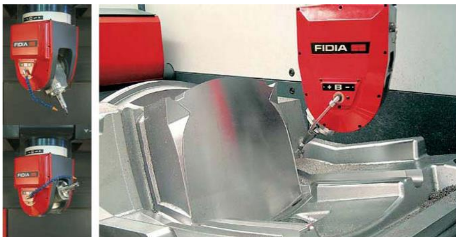
Σχήμα 1. 26 – Κεφαλή περιστροφικού άξονα σε μηχανή φραιζας, από Fidia.
