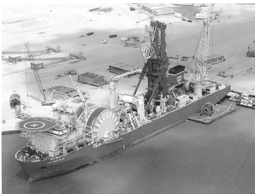
Σχήμα 2.14 Πλοίο της εταιρίας Technip που κάνει χρήση των μεθόδων Reel lay και J-lay για την τοποθέτηση υποθαλάσσιων αγωγών [ http://www.technip.com/ ].
