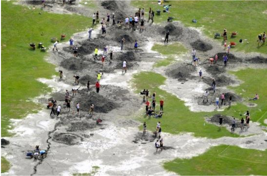
Σχήμα 3.6 Εμφάνιση του φαινομένου της ρευστοποίησης και της δημιουργίας κρατήρων άμμου στο Christchurch της Νέας Ζηλανδίας μετά τον σεισμό στις 28 Φεβρουαρίου 2011 [ http://planetark.org/ ].
