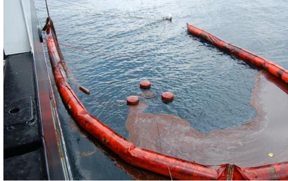
Σχήμα 10: Χρήση φραγμάτων και συσκευών απομάκρυνσης πετρελαίου στον κόλπο του Μεξικού (USCG, 2010).
