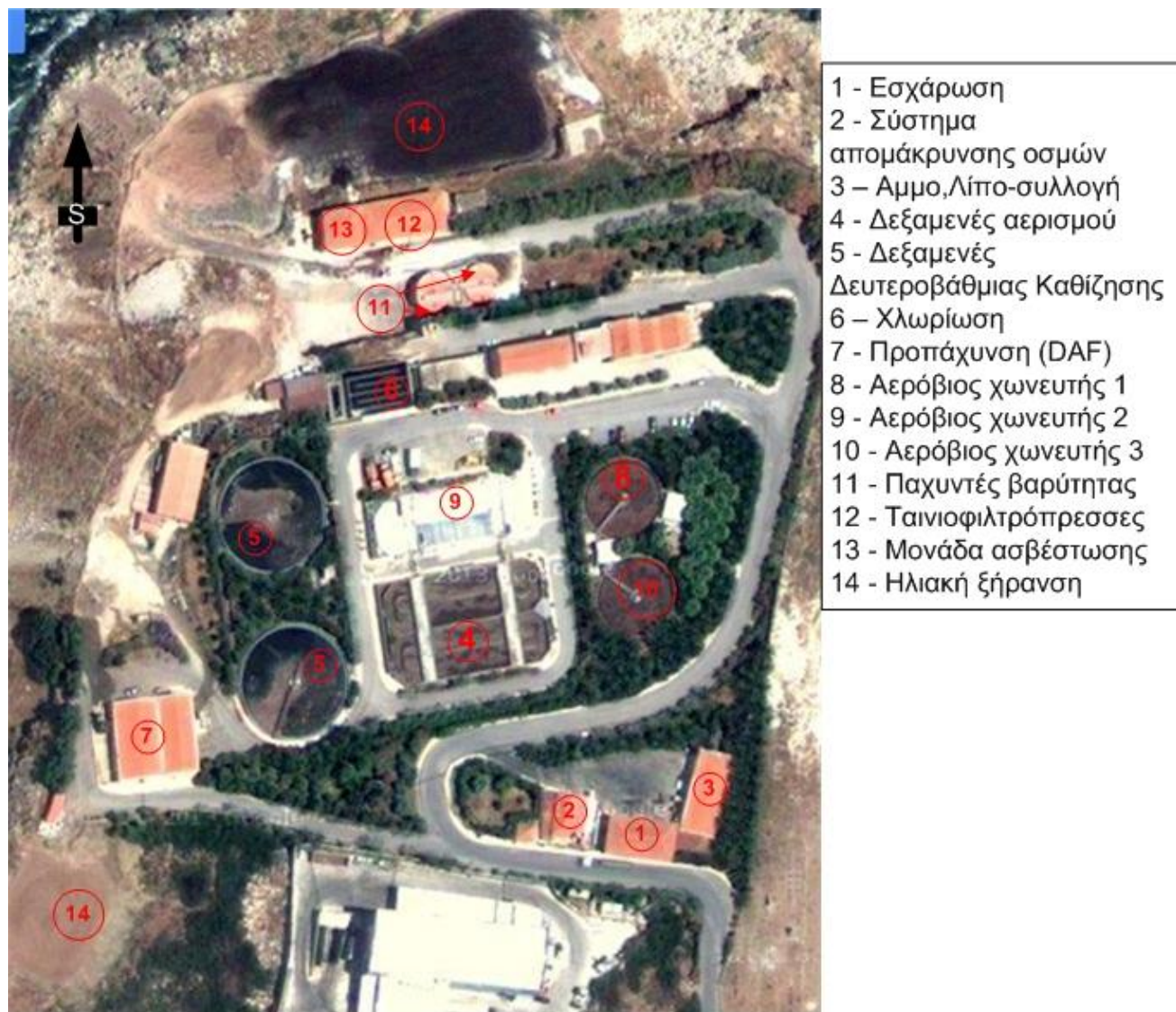
Εικόνα 1: Αεροφωτογραφία της ΕΕΛ Ρεθύμνου μέσω Google maps και οι διάφορες διεργασίες της μονάδας
