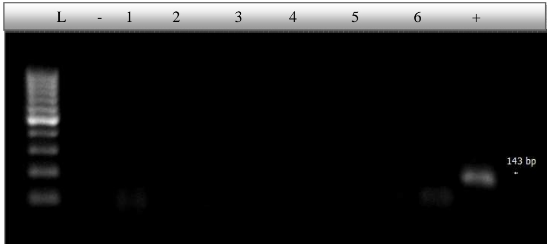
Εικόνα Δ.3.1.δ: Ηλεκτροφόρηση προϊόντων nested PCR για αδενοϊούς σε πήκτωμα αγαρόζης 1,5%, Διαδρομές→ L: ladder (100 bp), -: αρνητικό δείγμα, 1: Ηράκλειο 27/4 S1, 2: Ηράκλειο 27/4 S2, 3: Ηράκλειο 27/1 S3, 4: Ν. Κυδωνία 22/6 S1, 5: Ν. Κυδωνία 22/6 S2, 6: Ν. Κυδωνία 22/6 S3, +: θετικό δείγμα
