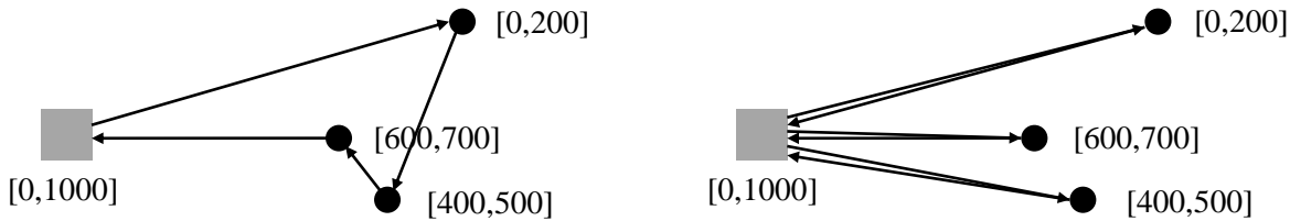
Σχήμα 4.1 Αριστερά η περίπτωση που συνυπολογίζεται η απόσταση με το χρονικό παράθυρο για την εύρεση του πιο ωφέλιμου πελάτη, ενώ στη δεύτερη λαμβάνεται υπ' όψιν μόνο η απόσταση.
