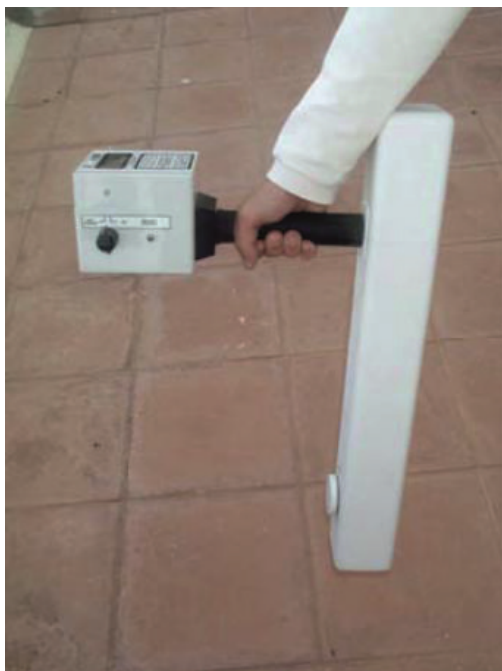
Εικόνα 3.3: Το διαφορικό μαγνητόμετρο ρυθμιζόμενης ροής
