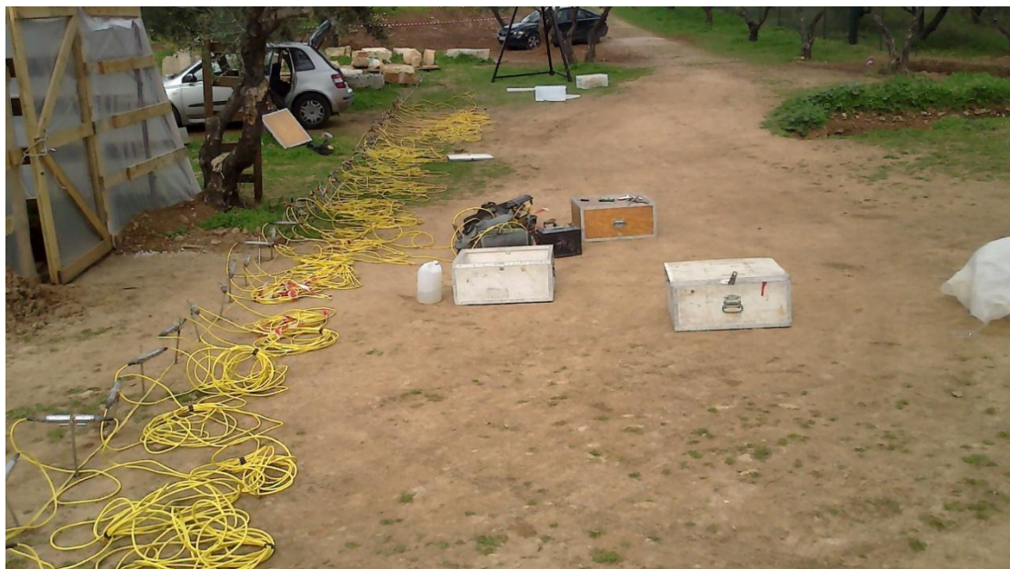
Εικόνα 4.2: Περιοχή B από νότια λήψη κατά την εκτέλεση ηλεκτρικής τομογραφίας διεύθυνσης N-B
