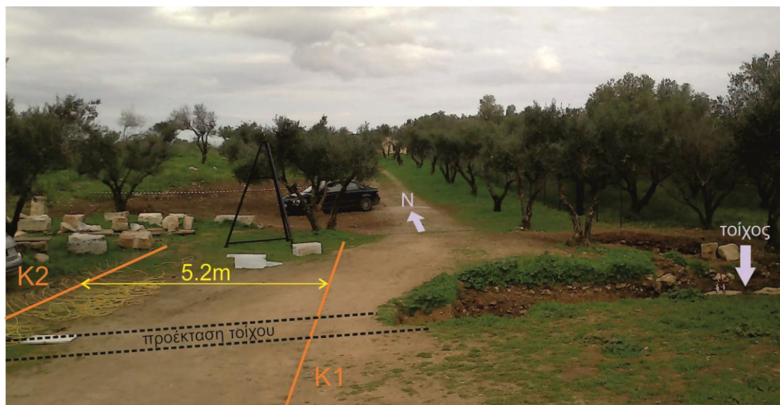
Εικόνα 4.3: Η διάταξη των ηλεκτρικών τομογραφιών K1, K2 στην περιοχή μελέτης
