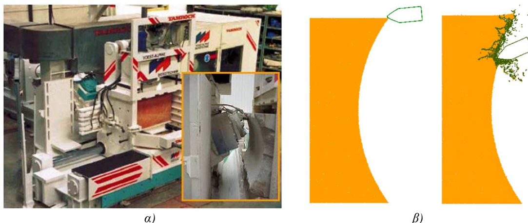
Σχήμα 2.4: Δοκιμές κοπής πετρωμάτων πάνω σε ευθεία ή καμπύλη διαδρομή: α) test rig ( Sandvik laboratory ), β) αριθμητική προσομοίωση δοκιμής.
