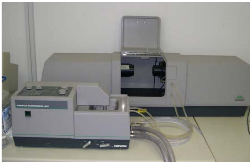
Εικόνα 7.1: Κοκκομετρικός αναλυτής Laser του Εργαστηρίου Εμπλουτισμού του Πολυτεχνείου Κρήτης.
