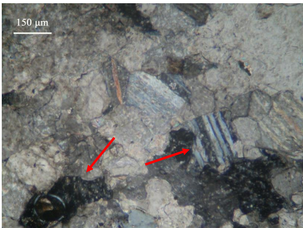
Εικόνα 5.12: Μικροφωτογραφία λεπτής τομής όπου διακρίνονται οι διδυμίες των κρυστάλλων ασβεστίτη καθώς και κρύσταλλος χαλαζία (XNicol).
