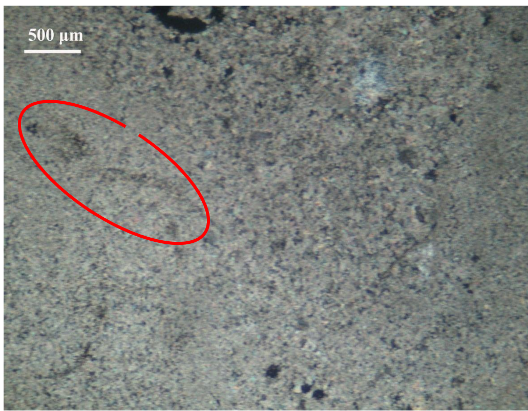
Εικόνα 5.19: Μικροφωτογραφία λεπτής τομής του δείγματος M2. Διακρίνονται ίχνη απολιθωμάτων πληρούμενα με σπαρίτη. (X Nicols).
