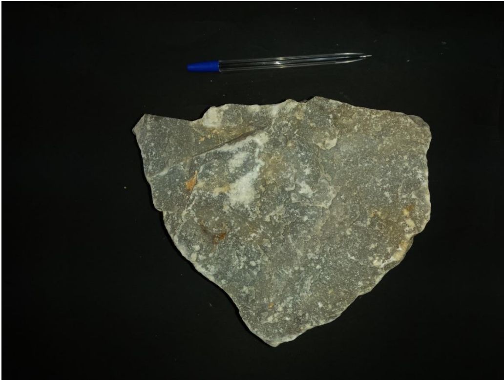
Εικόνα 5.16: Μικριτικός ασβεστόλιθος τεφρού χρώματος με ευδιάκριτο δίκτυο σπαριτικών φλεβών.
