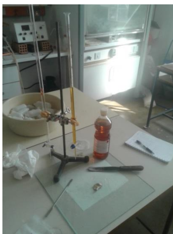
Εικόνα 7.3: Μέθοδος μέτρησης ελαιοαπορροφητικότητας
