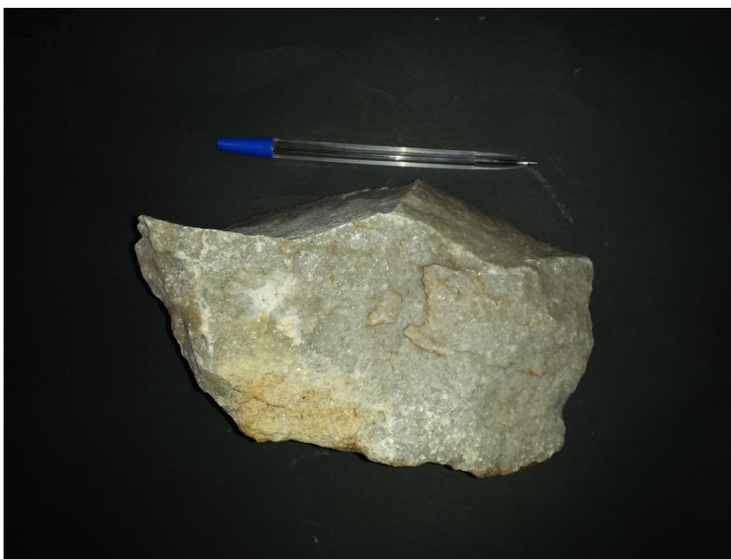
Εικόνα 5.15: Μικριτικός ασβεστόλιθος τεφρού χρώματος. Δείγμα M2.
