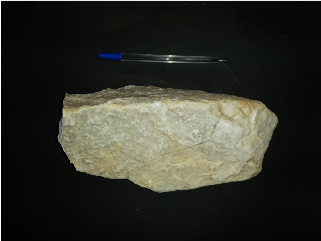
Εικόνα 5.8: Λεπτοκρυσταλλικό μάρμαρο λευκότεφρου χρώματος. Δείγμα M4.
