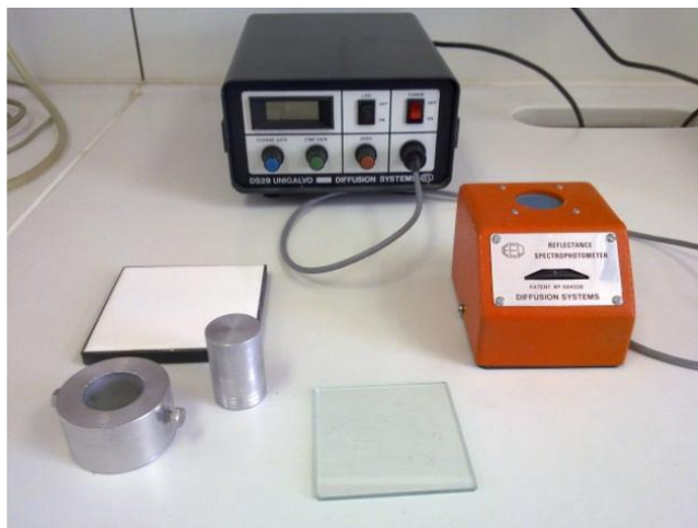
Εικόνα 7.2: Φασματοφωτόμετρο τύπου Evans Electroselenium Limited (EEL)Εργαστηρίου Πετρολογίας Πολυτεχνείου Κρήτης
