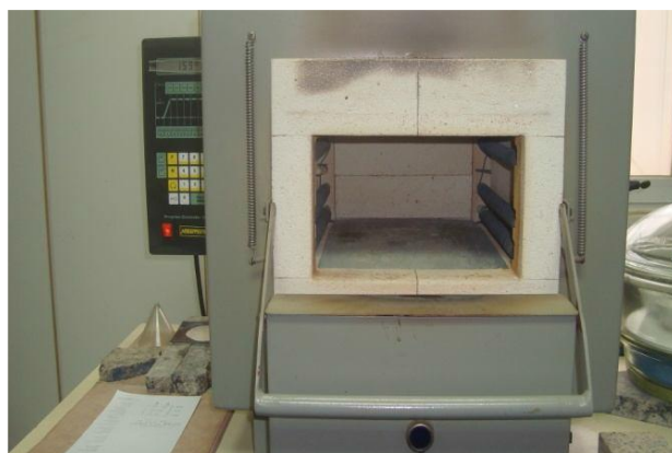
Εικόνα 6.1: Φούρνος έψησης του Εργαστηρίου Πετρολογίας του Πολυτεχνείου Κρήτης.
