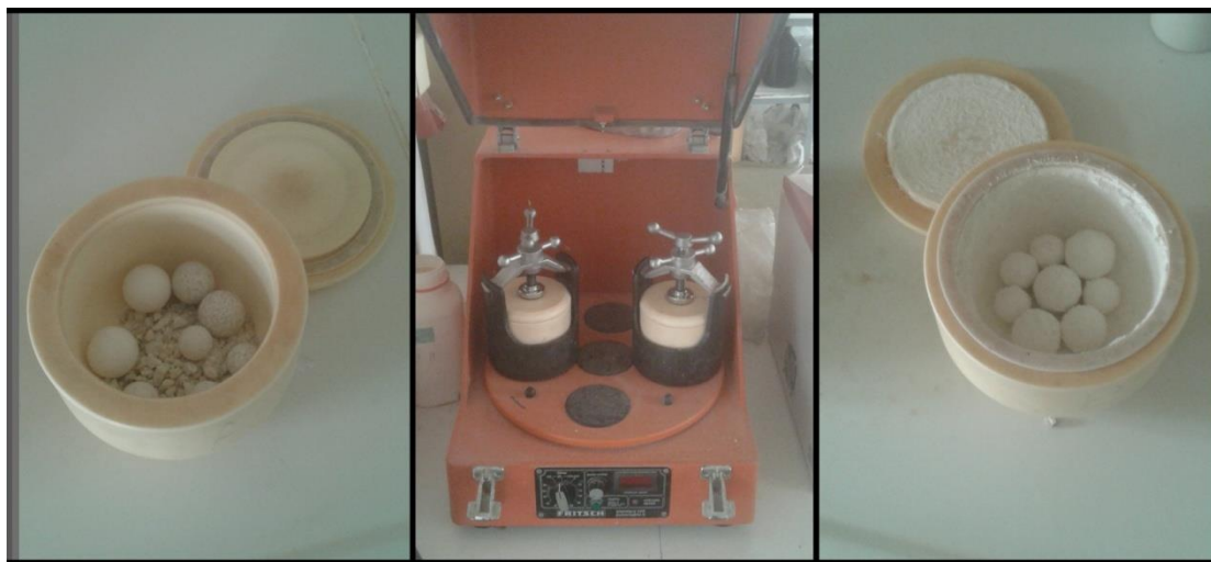
Εικόνα 4.9: Λειοτρίβηση δειγμάτων στον Αχάτη
