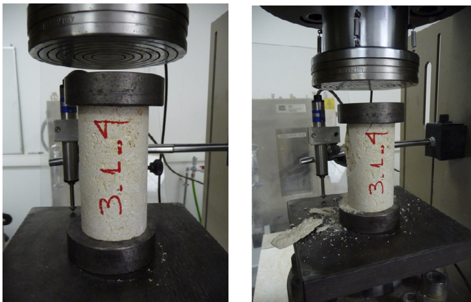
Εικόνα 3.14: Φωτογραφίες του 4ου δοκιμίου πριν και μετά τη θλίψη του στην πρέσα του Εργαστηρίου.
