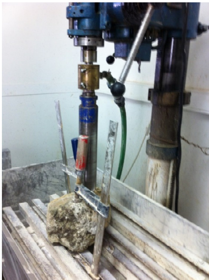
Εικόνα 3.11: Συσκευή λήψης πυρήνων από τα δείγματα.
