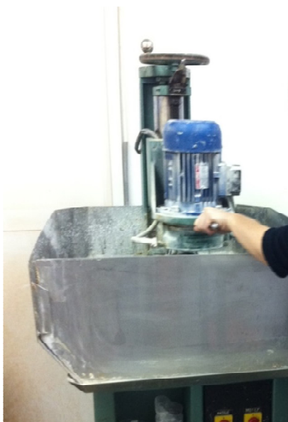
Εικόνα 3.13: Λείανση των επίπεδων επιφανειών των κυλίνδρων.
