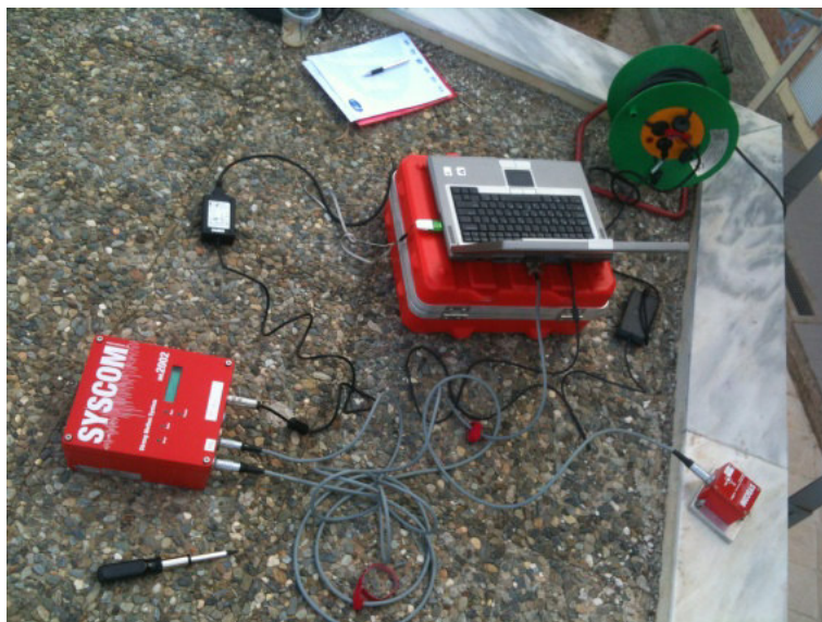
Εικόνα 5.3: Διάταξη των οργάνων που χρησιμοποιήθηκαν στις καταγραφές.
