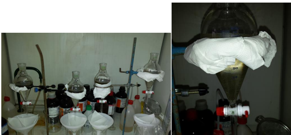
Εικόνα 3.4 Συστοιχία πειραματικής διάταξης (αριστερά) και λεπτομέρεια διαχωριστικής χοάνης (δεξιά)
