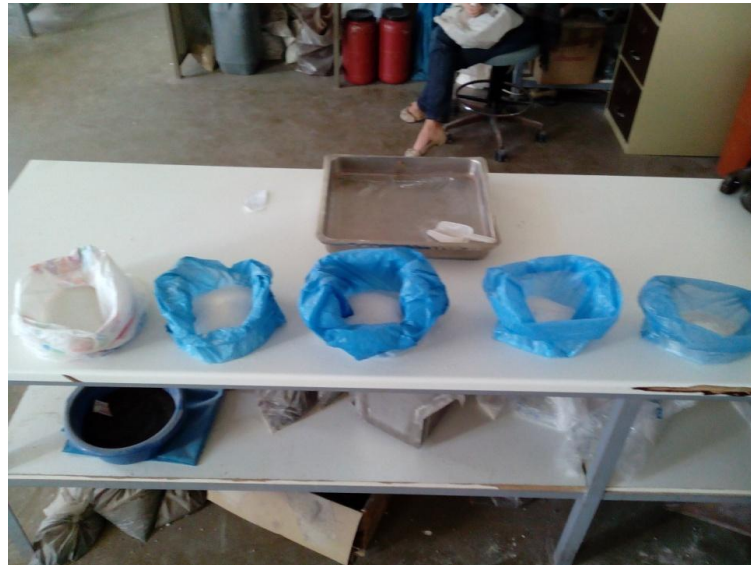
Εικόνα 6 Εικόνα ταξινόμησης κοκκομετρικών κλασμάτων των αδρανών κατά την παρασκευή τους
