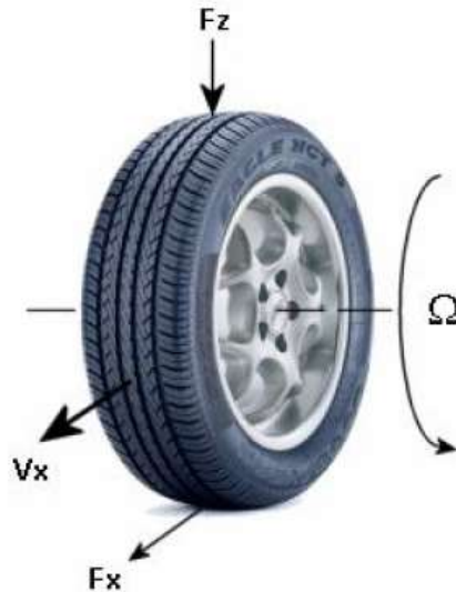
Εικ.4.5 Δυνάμεις που εφαρμόζονται στο υποσύστημα των ελαστικών.
