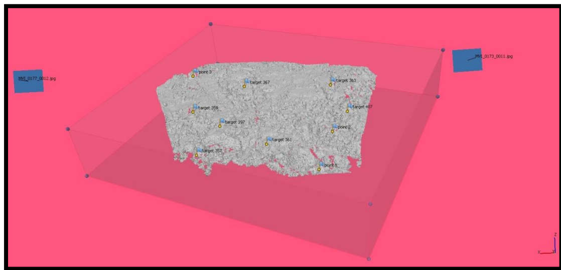
Εικόνα 4-5. Αποτέλεσμα βήματος ανακατασκευής πυκνού νέφους σημείων. Workflow -> Build Dense Cloud (Quality Ultra High, Depth filtering: Moderate, Frames: All frames).
