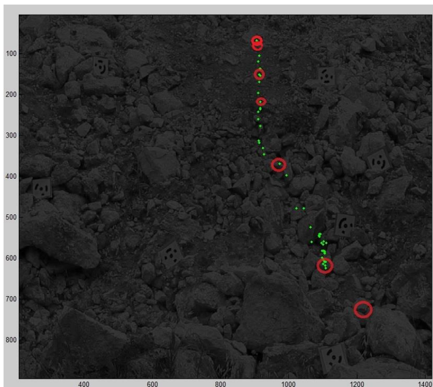
Εικόνα 6-2. Τροχιά βραχοτεμαχίου και καταγραφή από γεώφωνα.
