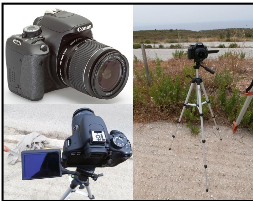
Εικόνα 3-4. Αριστερά Σώμα Φωτογραφικής Μηχανής Canon EOS 600D, δεξιά το τρίποδο που χρησιμοποιήθηκε.
