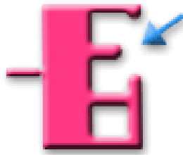
Σχήμα 3.26: Ατελής πλήρωση μιας κοιλότητας του καλουπιού
