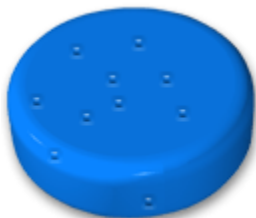
Σχήμα 3.21: Δημιουργία fish eyes στην επιφάνεια του αντικειμένου
