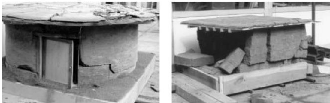
Εικόνα 4.1: Σύγκριση αποτελεσμάτων τρίτης και τέταρτης κρούσης πειράματος G. Minke.
