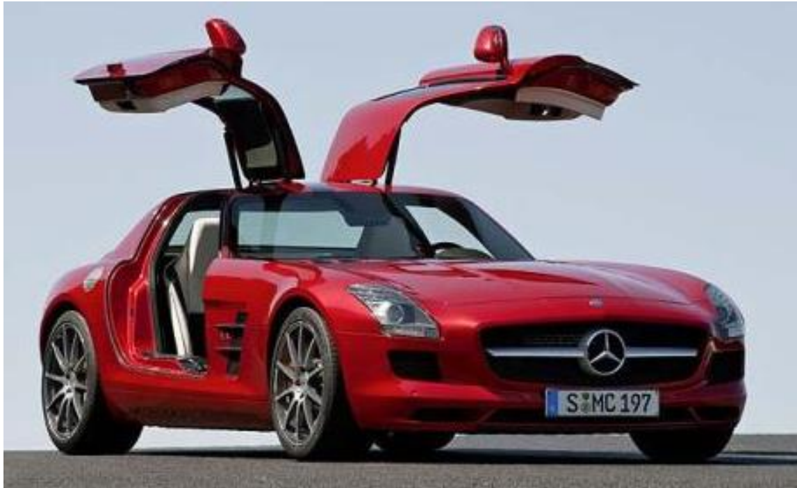
Εικόνα 2.4: Πόρτα τύπου ανοίγματος φτερών
