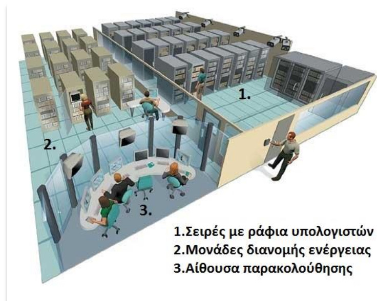
Εικόνα 2: Παράδειγμα εσωτερικής διάταξης των υπολογιστικών κέντρων (Fiberlink, 2014)
