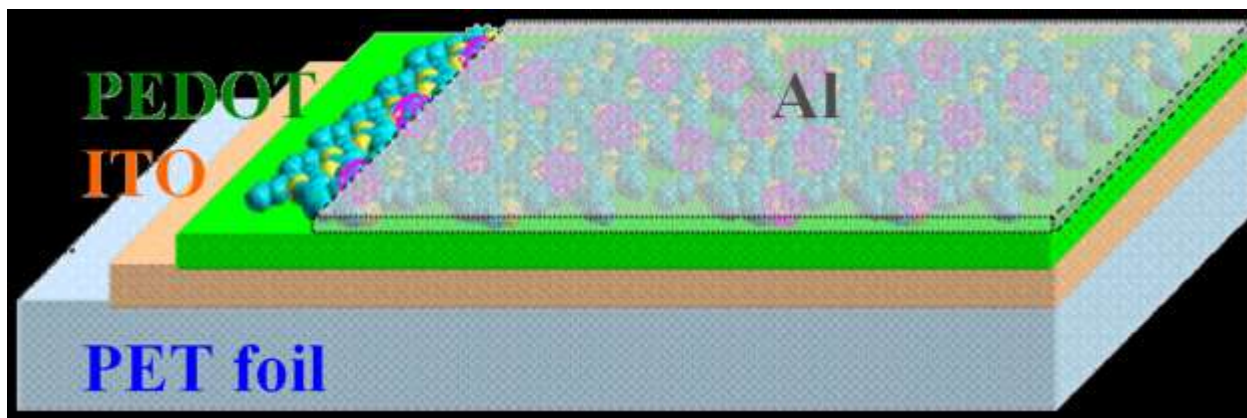
Σχήμα 25 Στρώσεις οργανικού φωτοβολταϊκού συστήματος [47]
