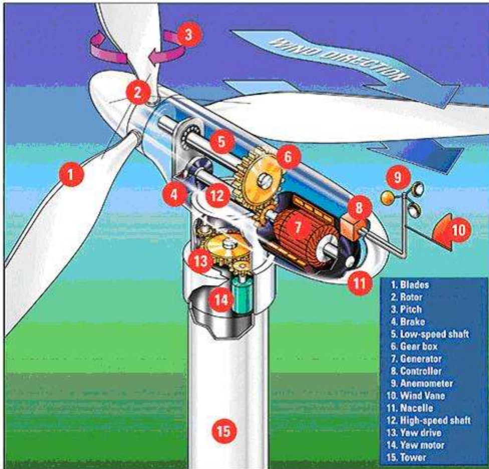
Σχήμα 85 Δομικά χαρακτηριστικά ανεμογεννήτριας [19]
