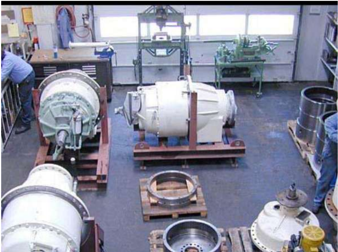
Σχήμα 88 Κιβώτιο ταχυτήτων ανεμογεννήτριας κατά την κατασκευή του [37]
