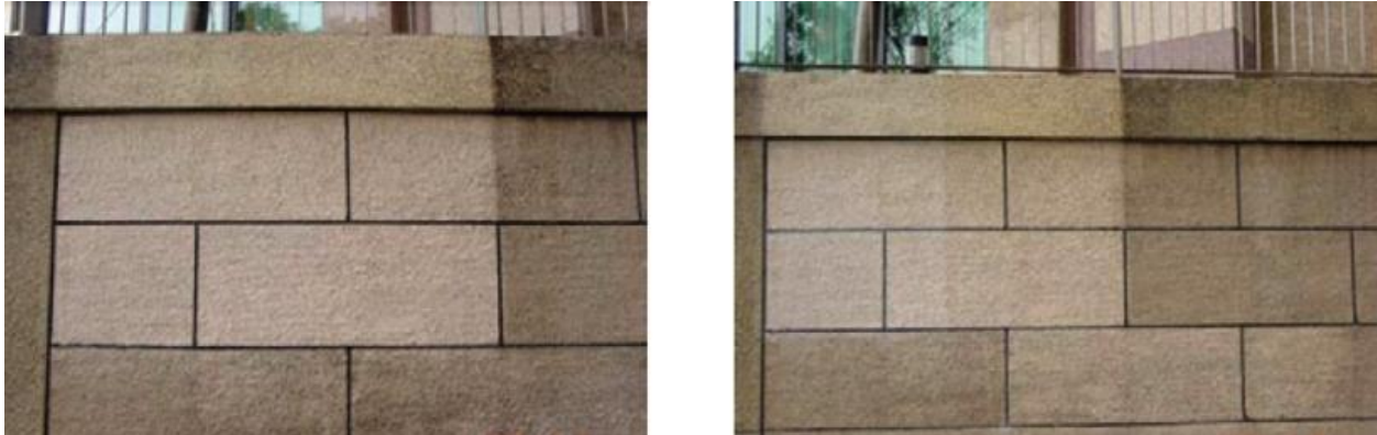
Εικόνα 8: Σύγκριση της επιφάνειας γρανίτη που έχει καθαριστεί και έχει εφαρμοστεί σε τμήμα αυτού φωτοκαταλύτης \text{TiO}_2 [59].
