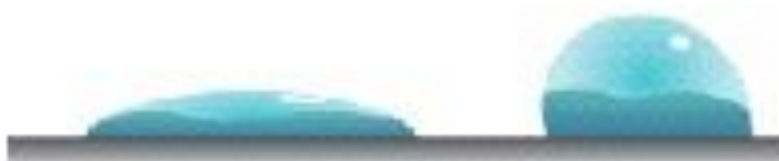
Εικόνα 10: Μεταβολή της γωνίας επαφής της σταγόνας νερού ως προς την επιφάνεια χάρη στην ανάπτυξη υπερυδρόφιλων ιδιοτήτων μετά από ακτινοβόληση υλικού το οποίο είναι επιφανειακά τροποποιημένο με \text{TiO}_2 [59].
