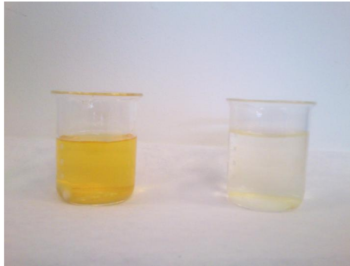
Εικόνα 27: Ο αποχρωματισμός της χρωστικής ΜΟ πριν και μετά τη φωτοκαταλυτική δράση των νανοσωματιδίων T_Fe0.10_500 στο UV.
