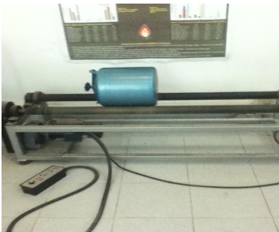
ε) Σφαιρόμυλος (ball mill)
