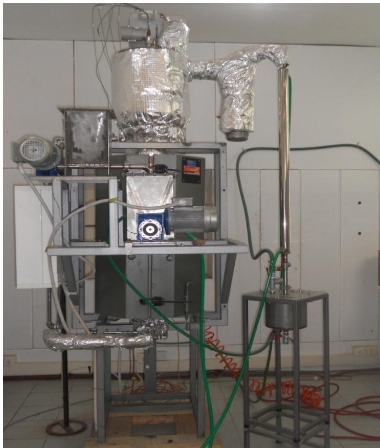
Εικόνα 3.1: Ρευστοποιημένη κλίνη
