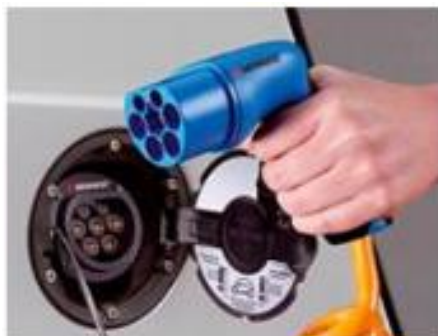
Εικόνα 5.4-2: Ρευματολήπτης τύπου 2 (φόρτιση AC) , 3/7/21Kw.
