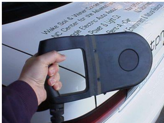
Εικόνα 3.4-3: Συσκευή paddle. Εισάγεται στη θύρα επαναφόρτισης του ηλεκτρικού οχήματος.
