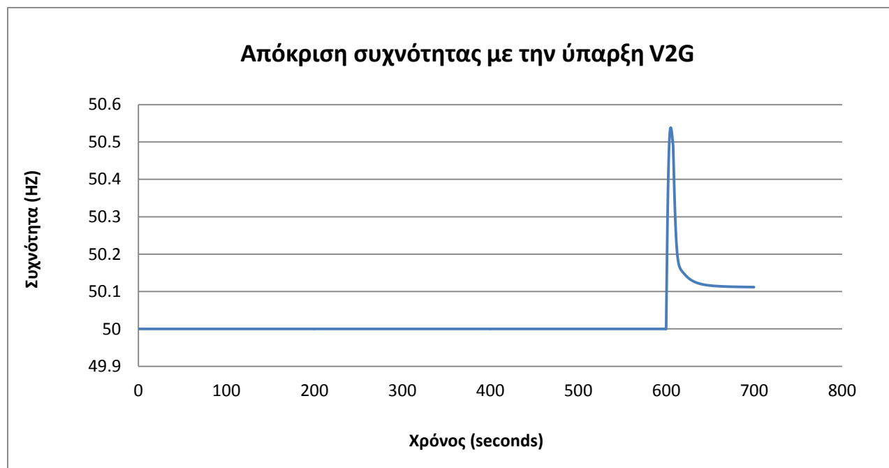
Γράφημα 9-28: Απόκριση συχνότητας πριν και κατά τη διαταραχή με την ύπαρξη V2G λειτουργίας στο σύστημα.
