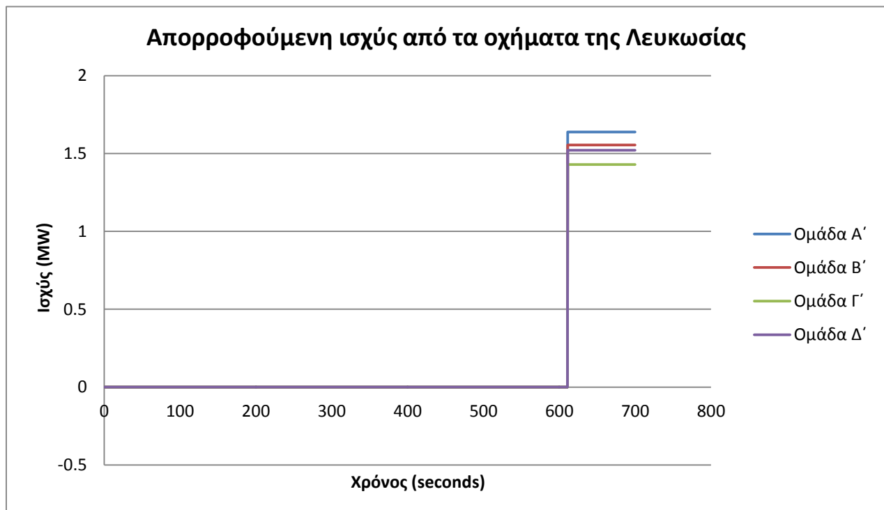
Γράφημα 9-35: Απορροφούμενη ισχύς από τα οχήματα της Λευκωσίας, μετρούμενη από την πλευρά του δικτύου.
