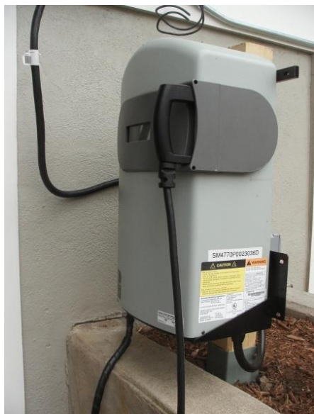
Εικόνα 3.4-2: Διάταξη επαγωγικής φόρτισης ηλεκτρικού οχήματος.
