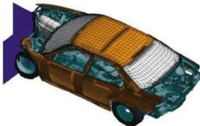
Εικόνα 2.17: Ανάλυση τροχαίου ατυχήματος με την χρήση πεπερασμένων στοιχείων
