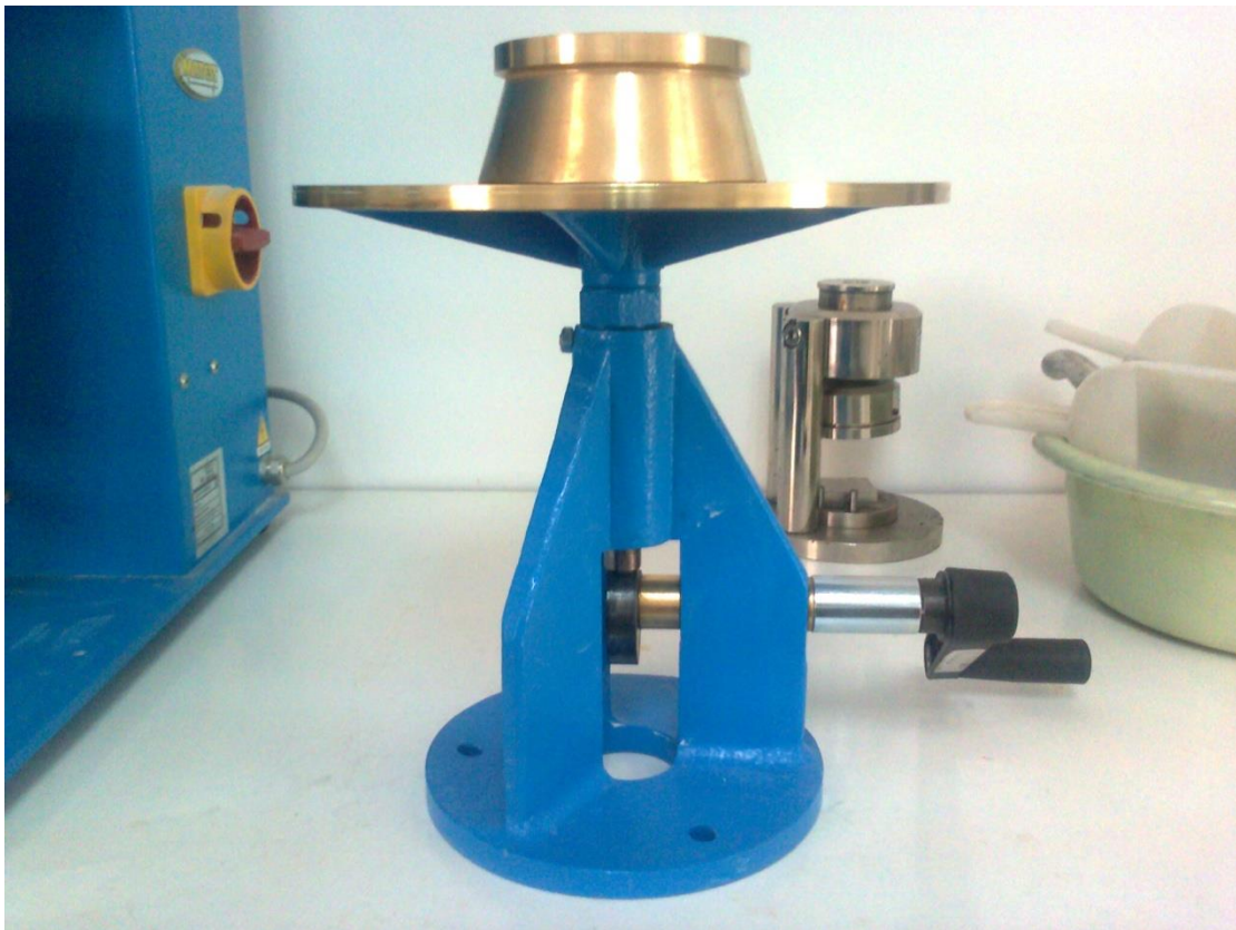
Εικόνα 7 : Συσσκευή Μέτρησης εξάπλωσης, (Πρότυπο ASTM C 1437 – 01). Η χειρολαβή με το μηχανισμό βοηθά την τράπεζα να κινείται κατακόρυφα.
