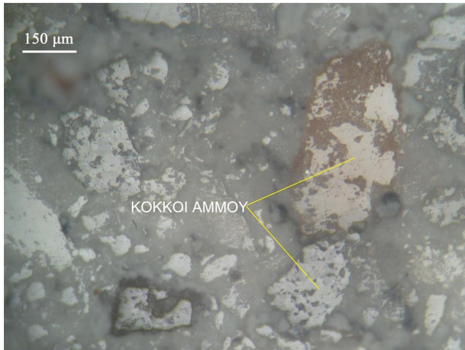
Εικόνα 17 : Μικροφωτογραφία στιλπνής τομής (πειραματικό δοκίμιο με σύνθεση 1:2:7 με 31,84% παιπάλη και 2% τρυγικό οξύ) μετά από 28 ημέρες ωρίμανσης σε πειραματικά δοκίμια. Οι κόκκοι της παιπάλης είναι ακανόνιστου σχήματος γωνιώδης η /και επιμήκης διεσπαρμένοι εντός του συνδετικού υλικού. Παρατηρούνται αλλοιωμένοι κόκκοι σε όλο το κονίαμα λόγω υψηλού ποσοστού επιβραδυντή. Οι κυκλικές οπές είναι φυσαλίδες εγκλωβισμένου αέρα. Ανακλώμενο φως // Nicols
