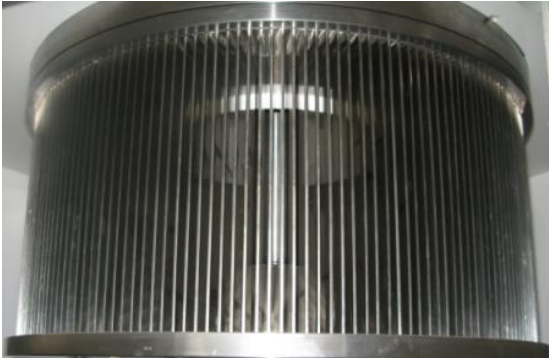
Εικόνα 1 : Περιστρεφόμενος κλωβός αεροταξινομητή
