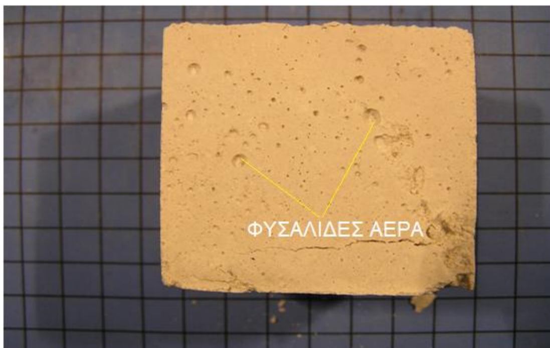
Εικόνα 20 : Μακροσκοπική φωτογραφία δοκιμίου A1( πειραματικό δοκίμιο με σύνθεση 1:2:5 με 31,84% παιπάλη) μετά από 28 ημέρες ωρίμανσης . Φαίνονται τα κενά αέρα μέσα στο κονίαμα.
