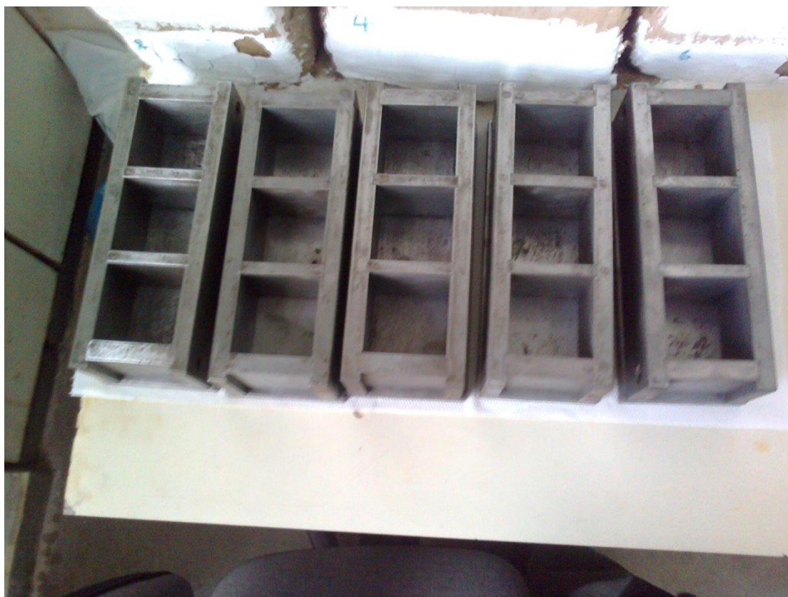
Εικόνα 6: Κυβικές μήτρες χύτευσης νωπού κονιάματος διαστάσεων 50x50x50 mm 3 κατά EN 1015-11 και EN 196-1.
