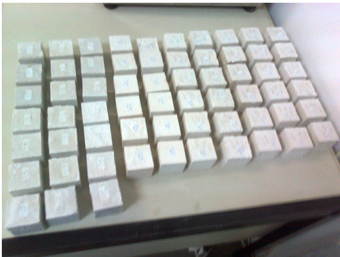
Εικόνα 9 : Κυβικά δοκίμια κονιαμάτων σε σκληρυμένη κατάσταση μετά από ωρίμανση 28 ημερών.
