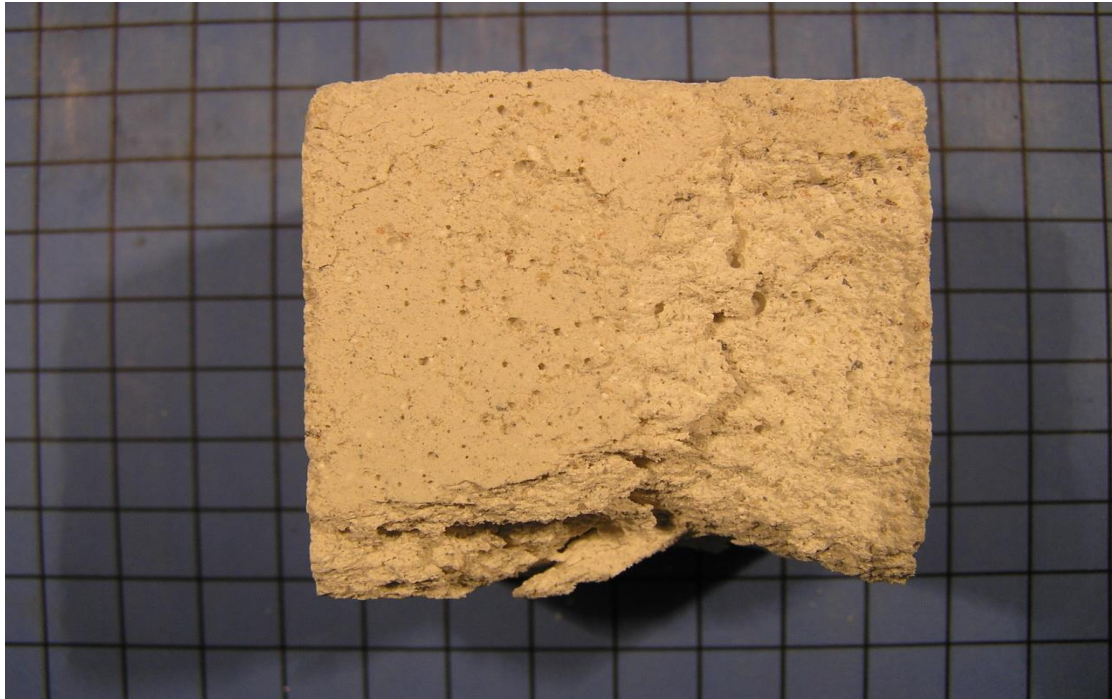
Εικόνα 22 : Μακροσκοπική φωτογραφία πειραματικού δοκιμίου B2 (πειραματικό δοκίμιο 1:2:6 με 23,19% παιπάλη και 2% τρυγικό οξύ) μετά από 28 ημέρες ωρίμανσης. Υπέστη μεγάλη αλλοίωση στη συνοχή του λόγω υψηλού ποσοστού επιβραδυντή. Φαίνονται τα κενά αέρα μέσα στο κονίαμα.
