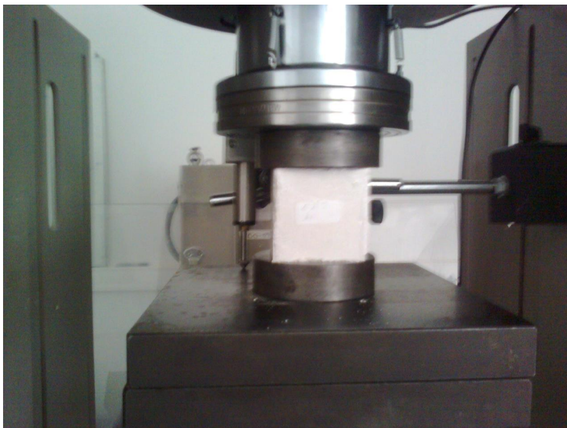
Εικόνα 10 : Διάταξη πλακών φόρτισης και δοκίμιο.
