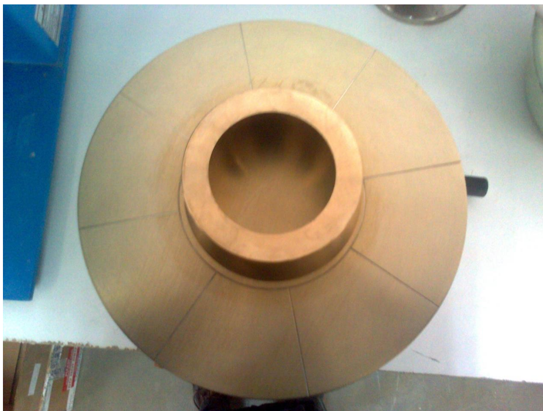
Εικόνα 8 : Συσκευή Μέτρησης εξάπλωσης, (Πρότυπο ASTM C 1437 – 01). Κώνος συγκεκριμένων διαστάσεων επάνω στην τράπεζα εξάπλωσης.
