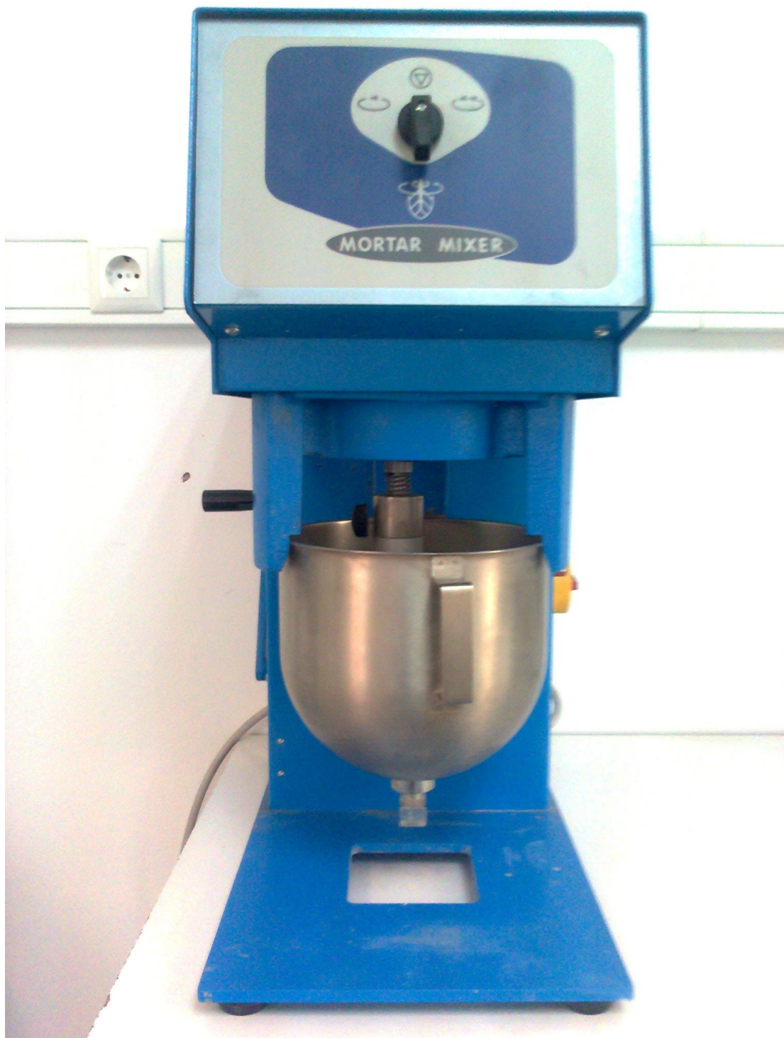
Εικόνα 5: Εργαστηριακός αναμικτήρας που χρησιμοποιήθηκε κατά EN 196/1.
