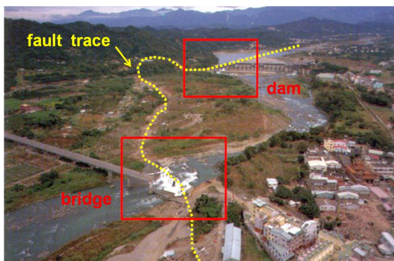
Εικόνα 2.11. Ζημιές σε τεχνικά έργα από μετακίνηση ρήγματος (Πηγή: Psarropoulos et al., 2013).
