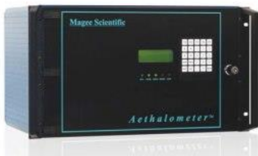
Εικόνα 42 Το αιθαλόμετρο που χρησιμοποιήθηκε για την μέτρηση του BC (Aethalometer – AE31, Magee Scientific).
