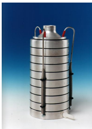
Εικόνα 24 Φωτογραφία του διαχωριστή πρόσκρουσης σωματιδίων Andersen impactor.
