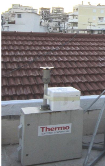
Εικόνα 60 Ο δειγματολήπτης Sequential στη θέση μέτρησης, στην πλατεία Δικαστηρίων, στην πόλη των Χανίων, τοποθετημένος στην ταράτσα δημόσιου κτιρίου (Ιανουάριος – Μάιος 2014).
