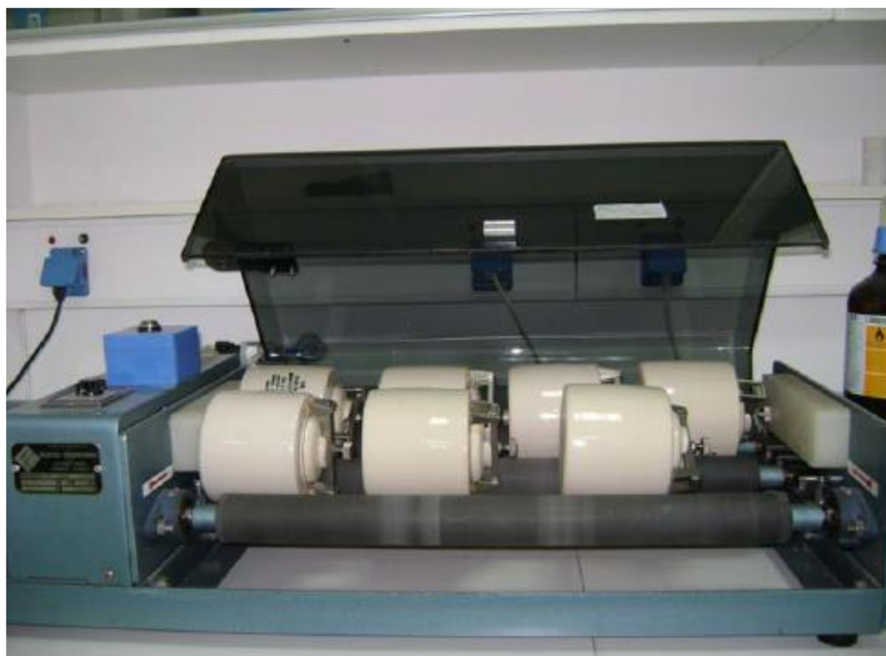
Σχήμα 5.2 Ο μύλος θρυμματισμού των δειγμάτων πετρωμάτων (Εργαστήριο Γεωλογίας).
