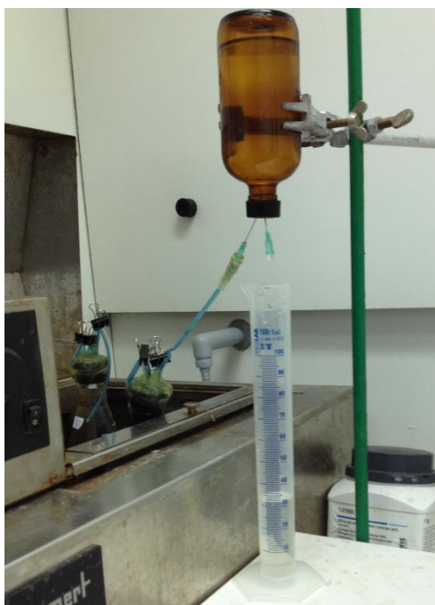
Εικόνα Β.6 – Βύθιση αντιδραστήρων σε υδατόλουτρο και ογκομέτρηση μεθανίου με διάλυμα KOH.
