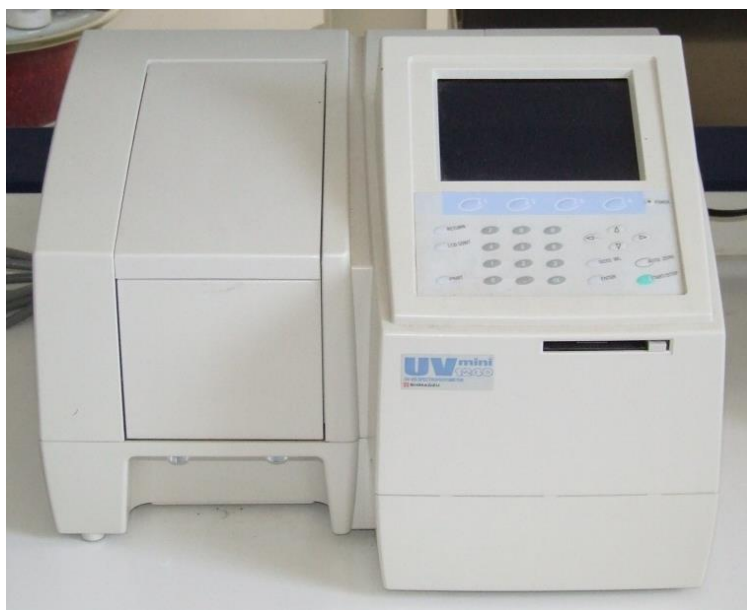
Εικόνα Β.14 – Φασματοφωτόμετρο UVmini 1240 (Shimadzu)
