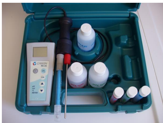
Εικόνα Β.10 – Φορητή συσκευή μέτρησης pH και δυναμικού οξειδοαναγωγής PH25 (CRISON)
