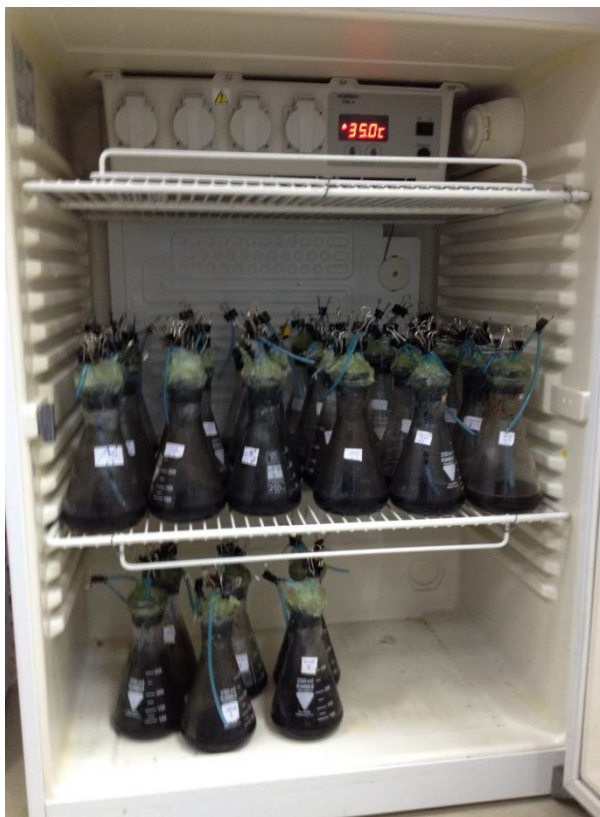
Εικόνα Β.5 – Αναερόβια χώνευση των αντιδραστήρων εντός του επωαστήρα.
