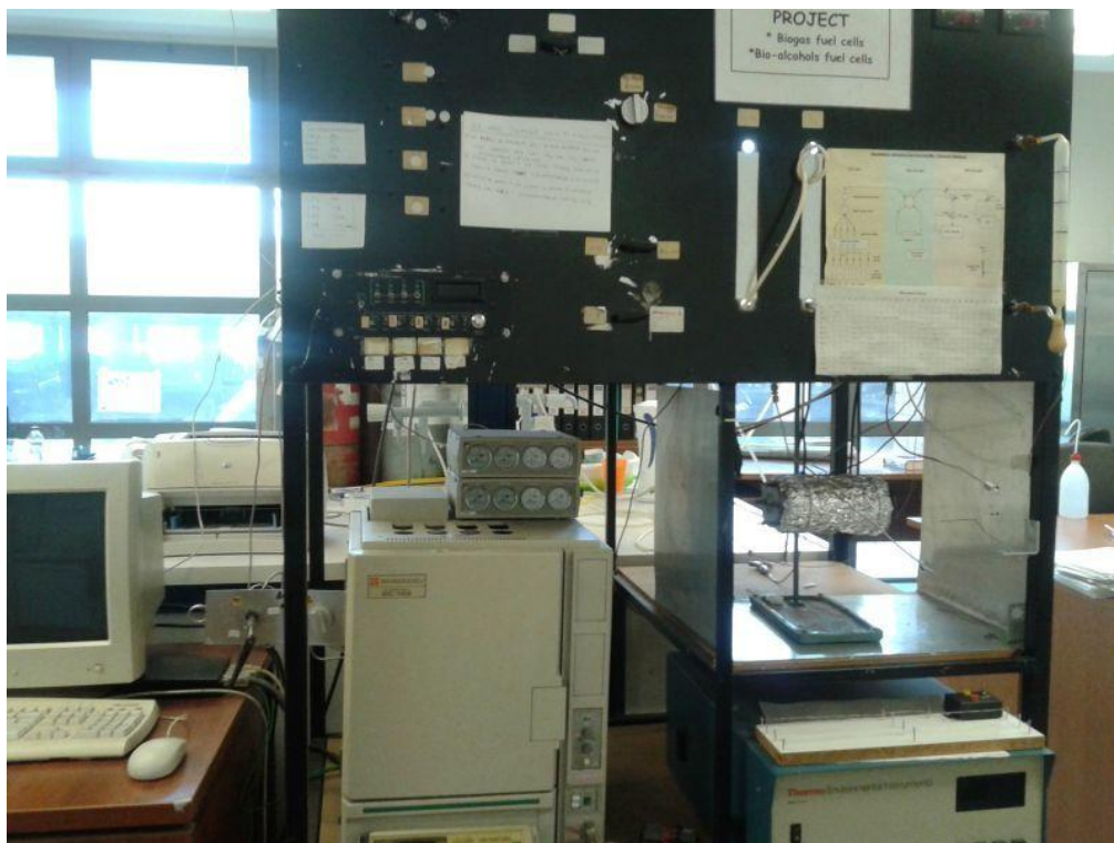
Σχήμα 3.8: Φωτογραφία της πειραματικής διάταξης της εσωτερικής ξηρής αναμόρφωσης του \text{CH}_4
