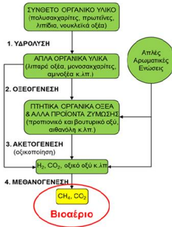
Σχήμα 2.1: Στάδια μετατροπής του οργανικού υλικού σε μεθάνιο και διοξείδιο του άνθρακα με τη διαδικασία της αναερόβιας χώνευσης (Li et al., 2011).
