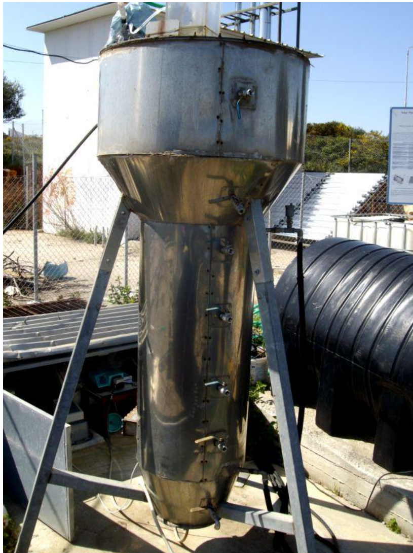
Σχήμα 3.1: Φωτογραφία διάταξης της πιλοτικής αναερόβιας χώνευσης που χρησιμοποιήθηκε στα πειράματα.
