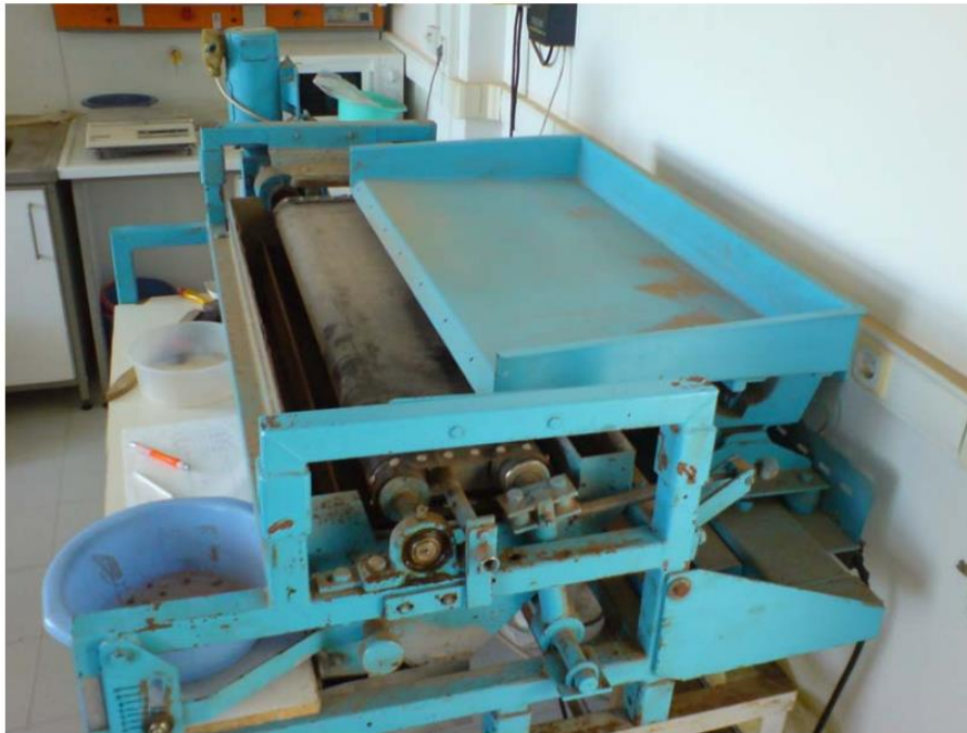
Σχήμα 2.3: Ταινιοφόρος μαγνητικός διαχωριστής εργαστηρίου Εμπλουτισμού
